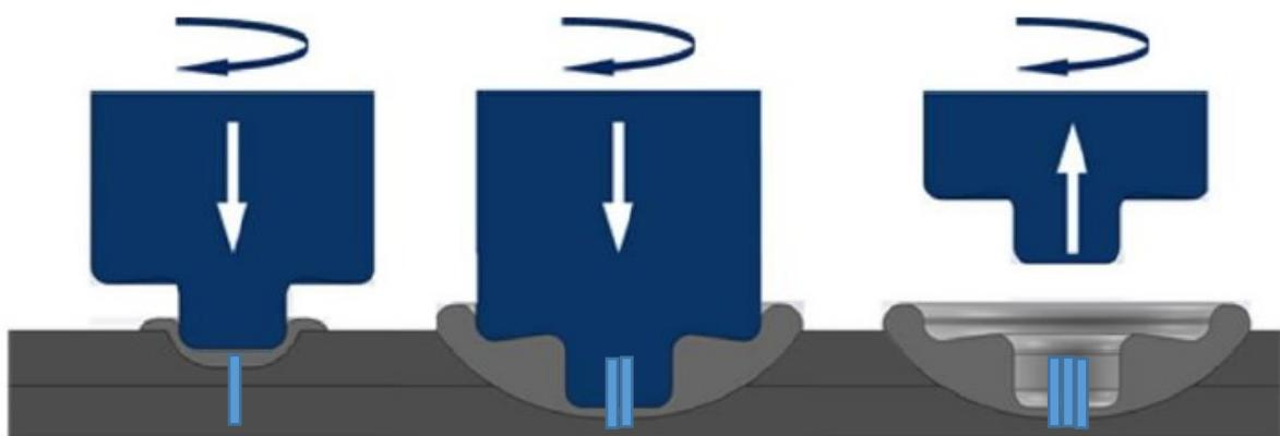
Slika 4. Faze procesa zavarivanja FSSW postupkom [6]
