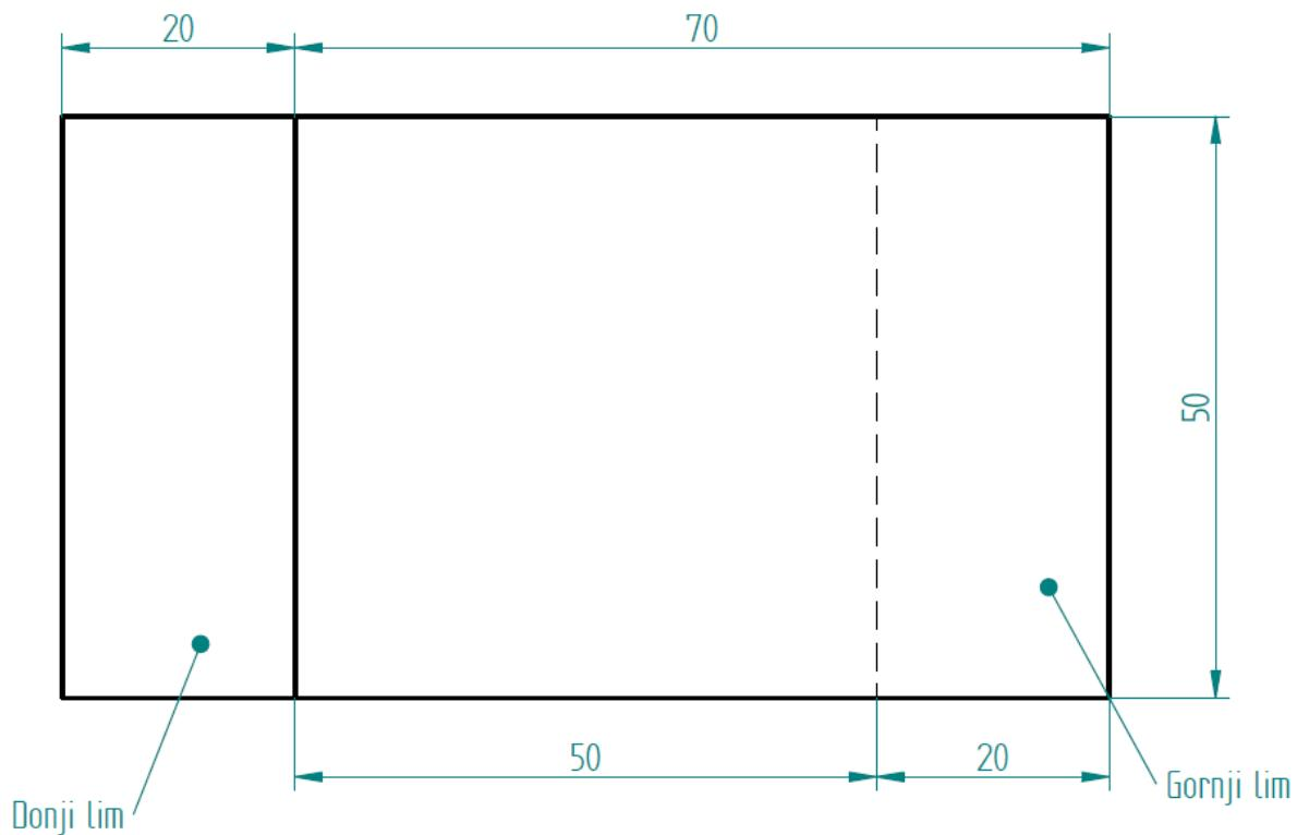
Slika 20. Preklop limova prilikom zavarivanja
