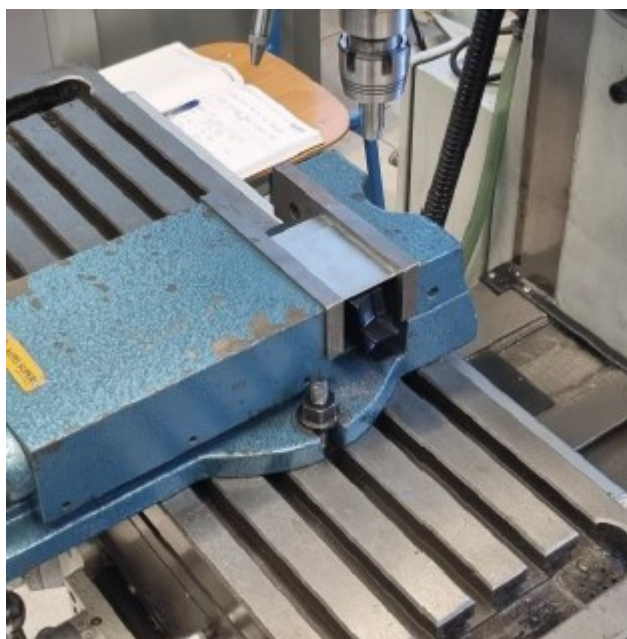
Slika 24. Pločice postavljene u škrip, prije procesa zavarivanja
