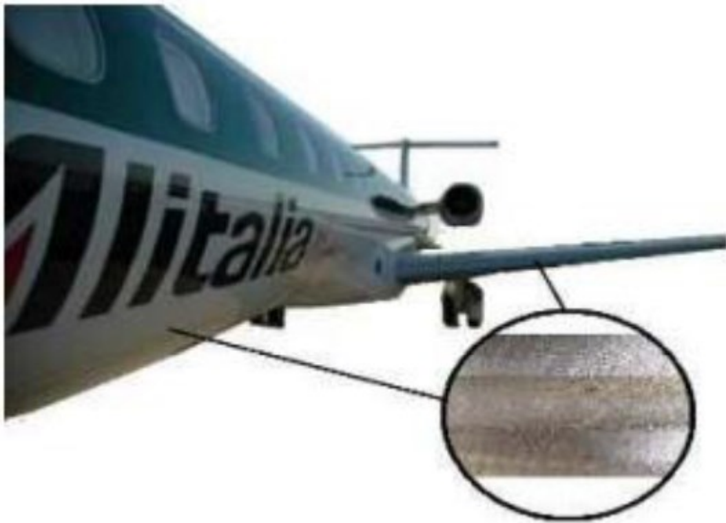
Slika 9. Trup i krilo zrakoplova zavareni FSW postupkom [9]
