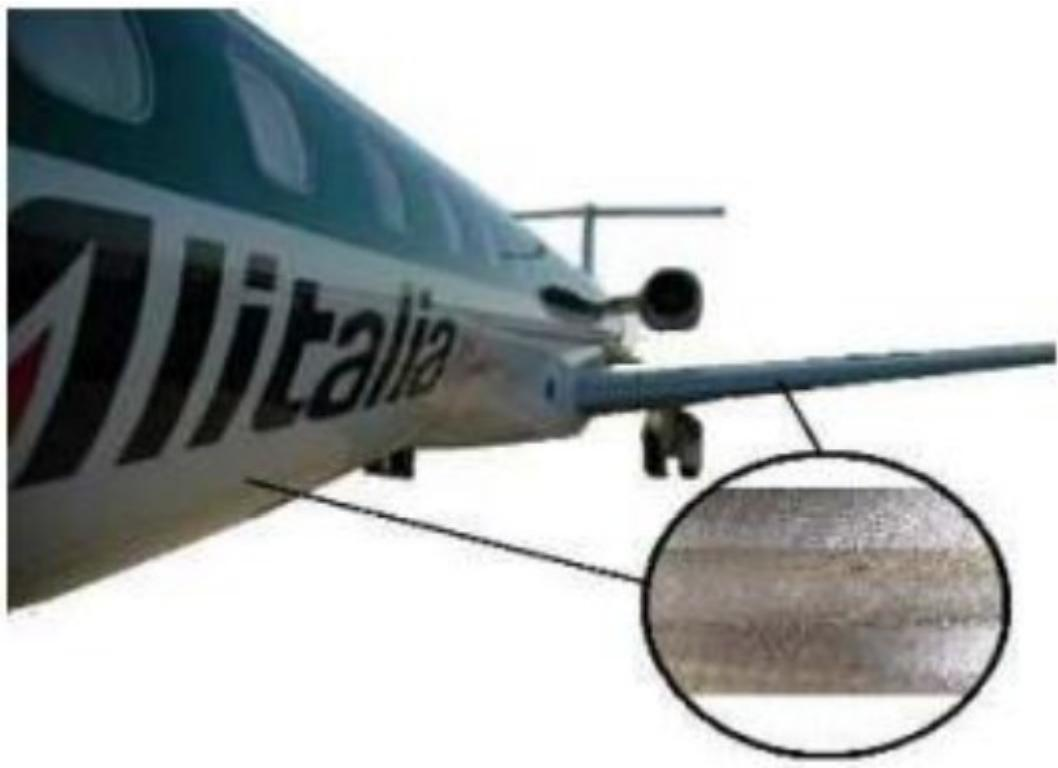
Slika 9. Trup i krilo zrakoplova zavareni FSW postupkom [9]
