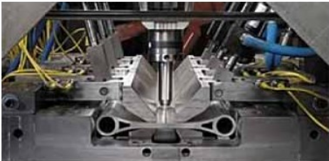
Slika 12. Primjena FSW postupka u automobilskoj industriji [8]
