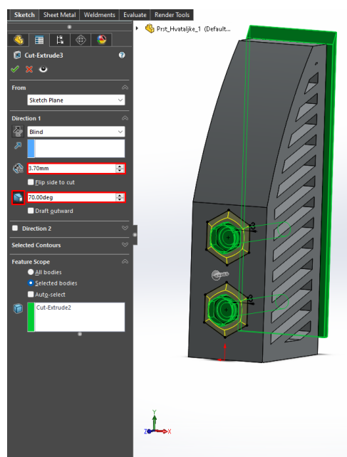
Slika 5.18. Proces zakošenja glave vijka
