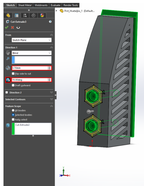
Slika 5.18. Proces zakošenja glave vijka
