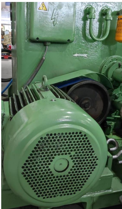
Slika 5.1. Vizualna provjera smjera okretanja elektromotora uz naznačeni smjer vrtnje na uljnom reduktoru
