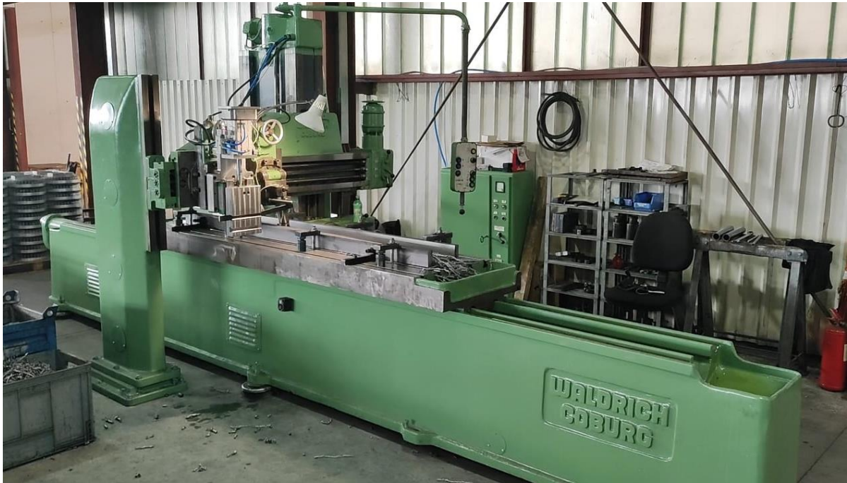
Slika 2.2. Uređaj za pravolinijsko rezanje metala
