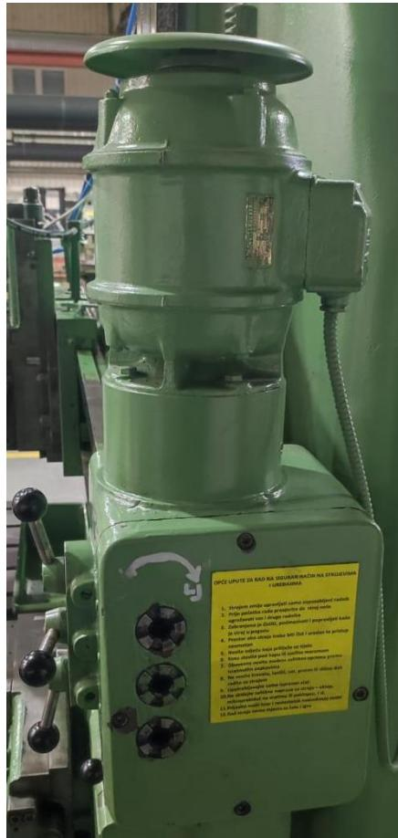
Slika 2.11. Elektromotor za brzi posmak suporta
