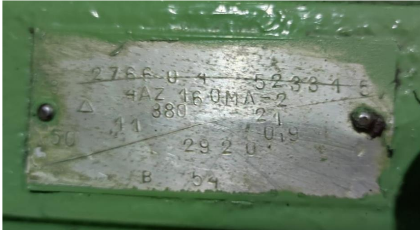
Slika 2.8. Natpisna pločica s nazivnim podacima pogonskog elektromotora
