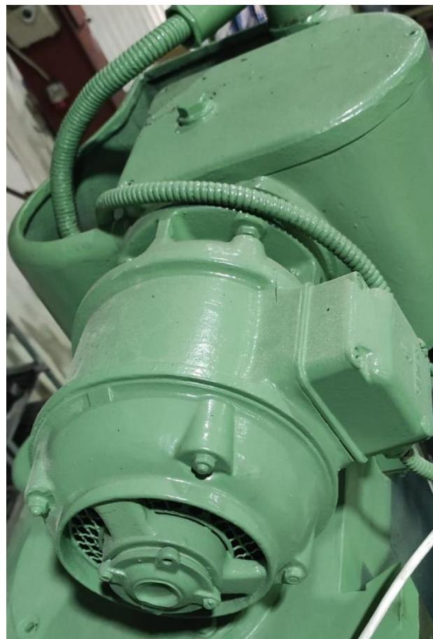
Slika 2.13. Elektromotor za pokretanje konzole
