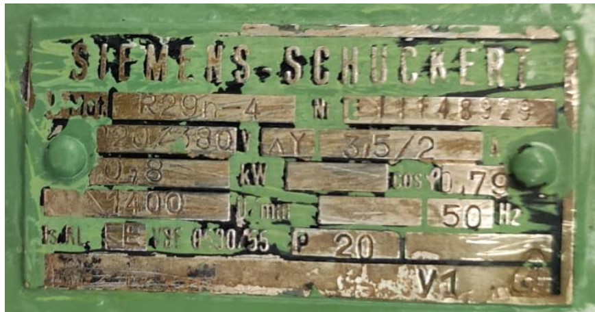
Slika 2.10. Natpisna pločica s nazivnim podacima elektromotora za brzi posmak suporta
