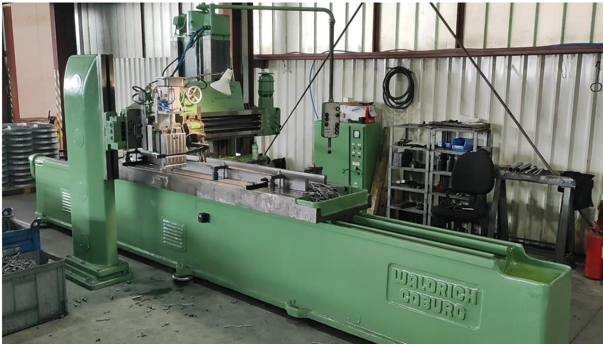
Slika 2.2. Uređaj za pravolinijsko rezanje metala
