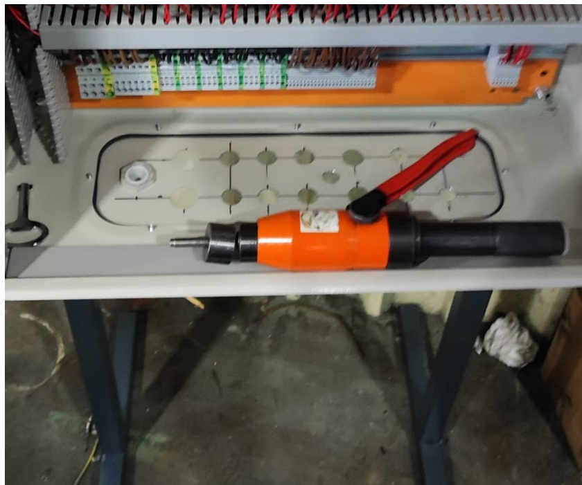
Slika 4.4. Bušenje rupa za uvodnice prema nacrtanom rasporedu
