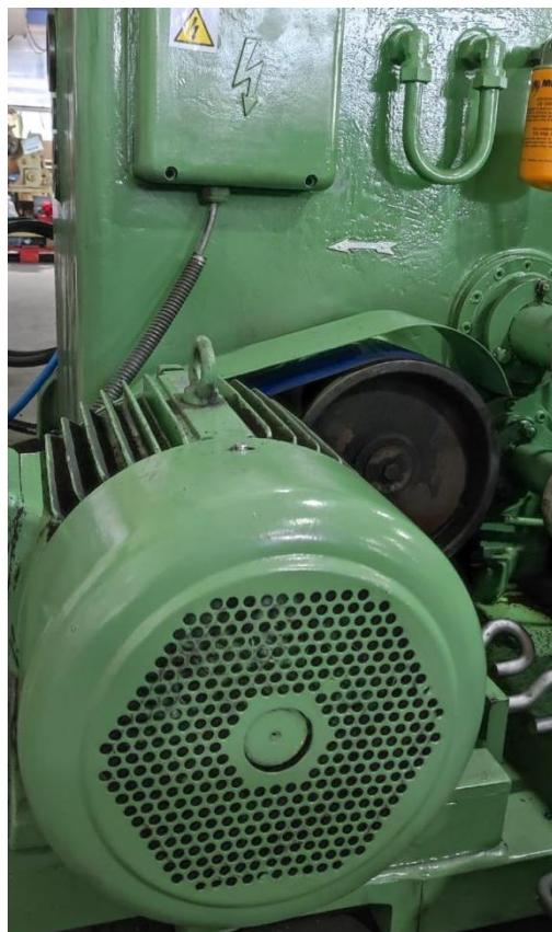
Slika 5.1. Vizualna provjera smjera okretanja elektromotora uz naznačeni smjer vrtnje na uljnom reduktoru
