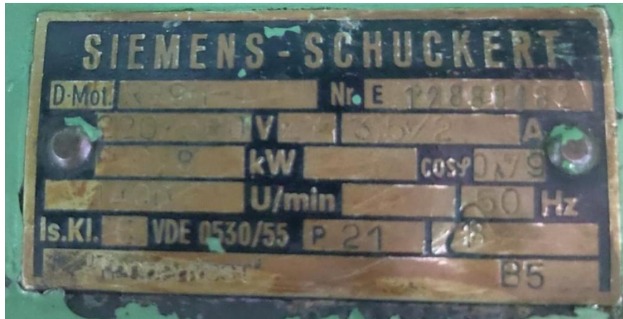
Slika 2.12. Natpisna pločica s nazivnim podacima elektromotora za pokretanje konzole
