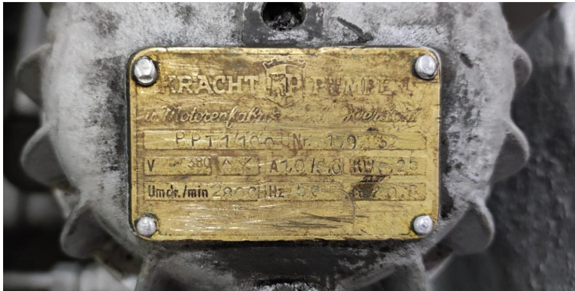
Slika 2.4. Natpisna pločica s nazivnim podacima propusne pumpe
