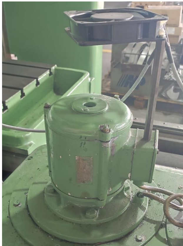
Slika 2.15. Elektromotor za kretanje stola
