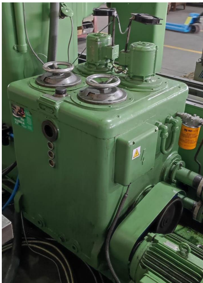
Slika 2.3. Uljni reduktor blanjalice
