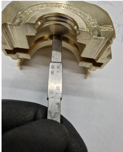
Slika 44: NO GO strana kontrolnog listića. [24]
