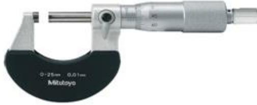
Slika 19: Mikrometar za vanjsko mjerjenje promjera. [19]
