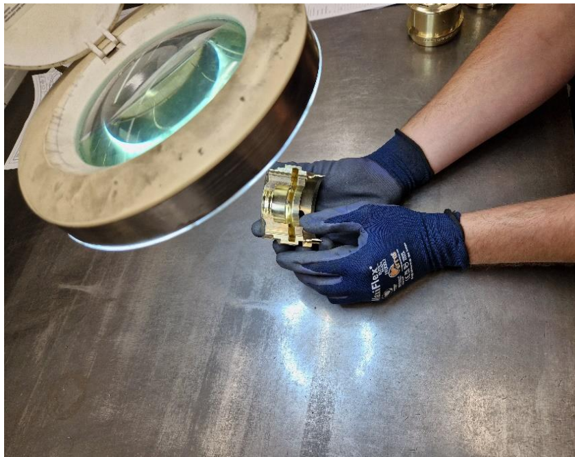
Slika 31: Kontrola oštećenja i poroznosti. [24]
