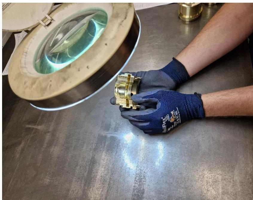
Slika 31: Kontrola oštećenja i poroznosti. [24]
