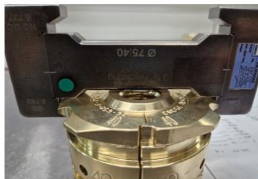
Slika 41: Kontrola visine i promjera prizme. [19] [24] [24]
