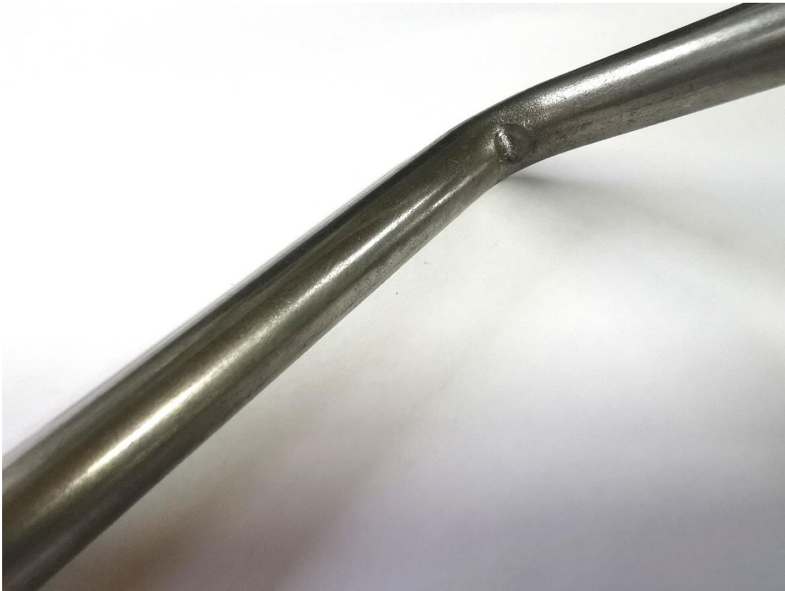
Slika 4.3: Otisak od alata na unutarnjem radijusu savijene žice
