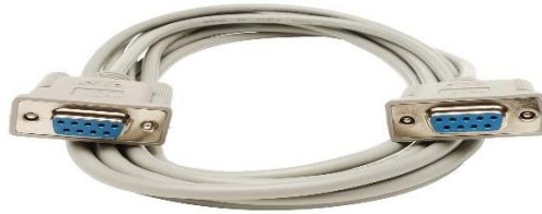
Slika 18. RS232 kabel pomoću kojeg se SIMOREG spaja s računalom
