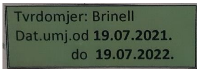
Slika 12. Primjer interne naljepnice ispravnosti opreme [13]
