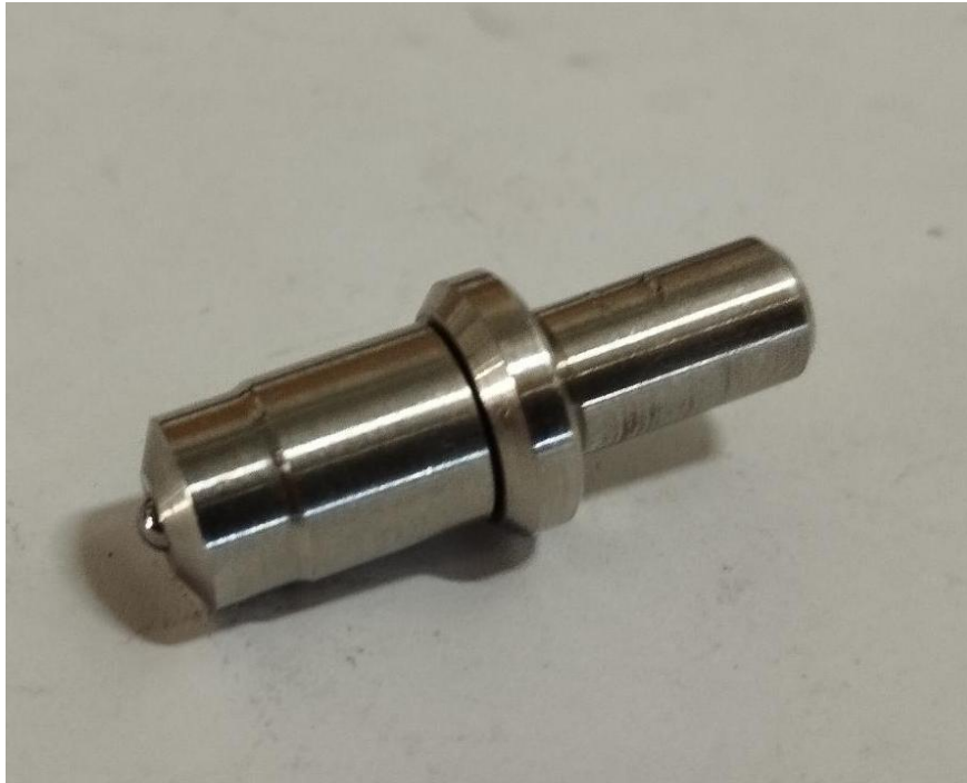
Slika 41. Primjer utiskivala s kuglicom 2,5mm [13]
