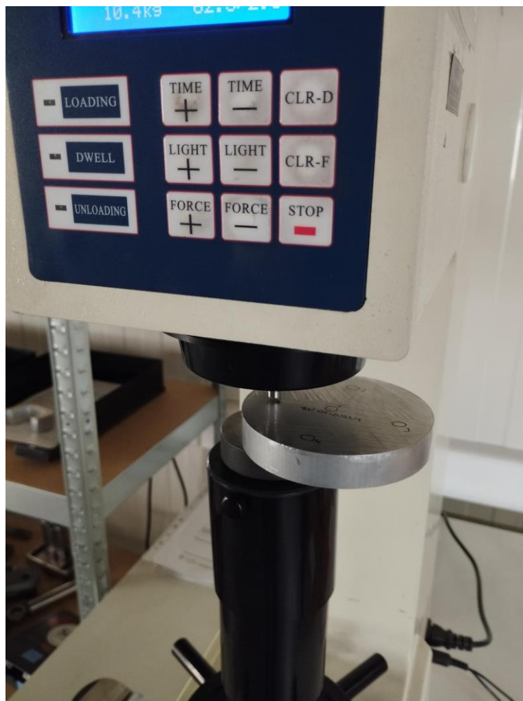
Slika 42. Primjer ispitivanja na tvrdomjeru [13]
