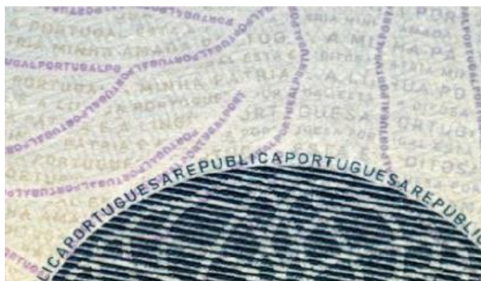
Slika 18: Tisak linija i teksta pomoću mikrotiska Izvor [10]
