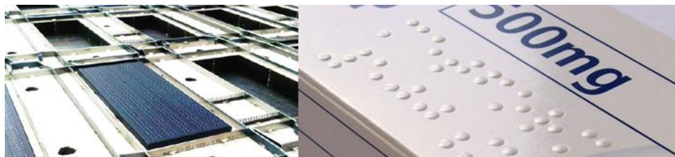
Slika 15: Štancanje kartonske kutije pomoću matrice/patrice Izvor [32]
