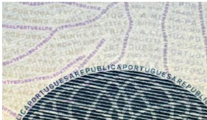
Slika 18: Tisak linija i teksta pomoću mikrotiska Izvor [10]
