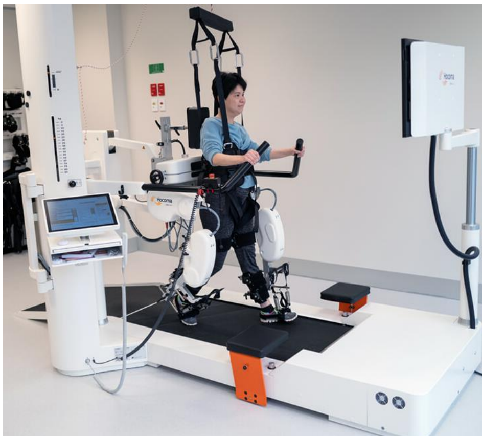
Slika 3.2.3.1. Prikaz Lokomat egzoskeletona
