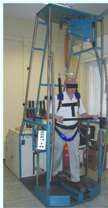
Slika 3.2.1.1. Prikaz uporabe Gait Trainer robota
