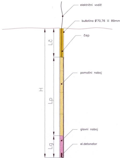
**Slika 8. Konstrukcija minske bušotine** (Preuzeto: [www.info.grad.hr](http://www.info.grad.hr), 02.10.2015)
