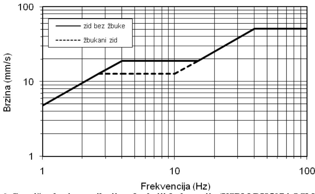
**Slika 6. Granične brzine oscilacija u funkciji frekvencije (USBM RI8507 i OSM standard)** (preuzeto: Strelec S., 2007)
