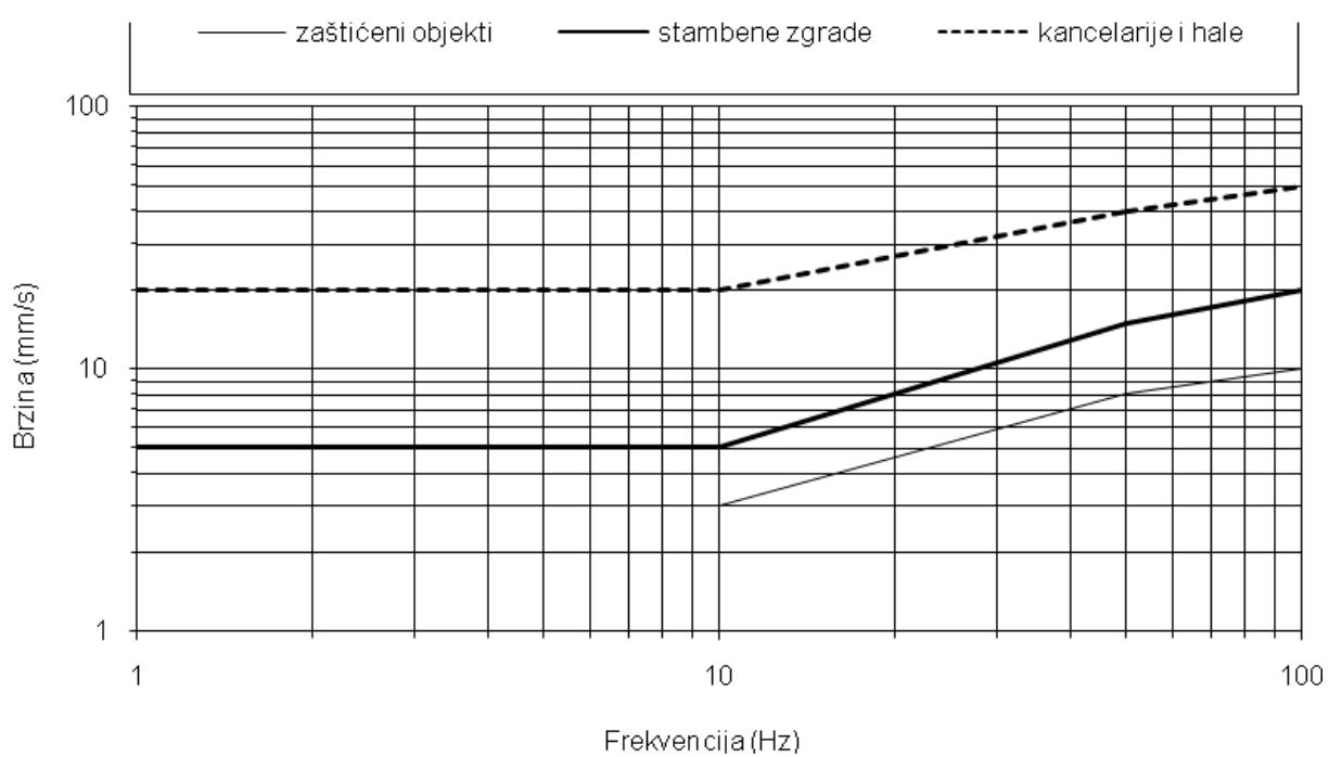
**Slika 5. Grafički prikaz graničnih brzina oscilacija po DIN 4150 standardu** (preuzeto:
