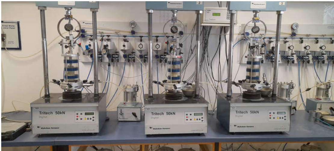
Slika 36.: Sustav za troosno ispitivanje tla, (fotografirano uz dozvolu IGH, 2023.)
