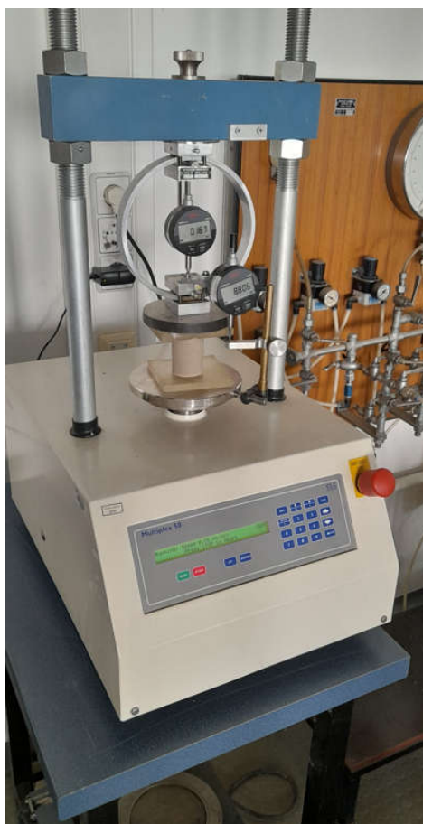
Slika 29: Preša za ispitivanje jednoosne tlačne čvrstoće, (fotografirano uz dozvolu IGH, 2023.)
