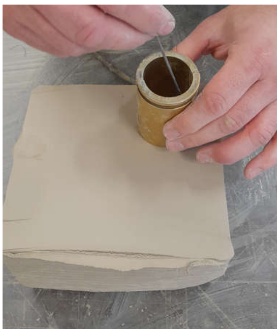
Slika 30.: Priprema i obrada uzorka za ispitivanje jednoosne tlačne čvrstoće iz bloka, (fotografirano uz dozvolu IGH, 2023.)
