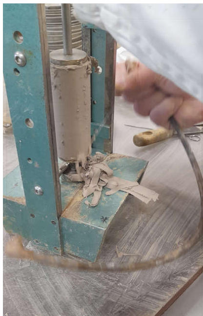
Slika 31.: Obrada uzorka u trimeru, (fotografirano uz dozvolu IGH, 2023.)
