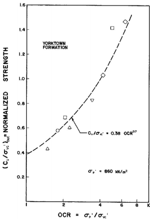
Slika 9. Nedrenirana čvrstoća za osjetljive gline sa primjesama pijeska, u ovisnosti o stupnju prekonsolidacije OCR [5]
