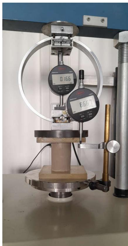
Slika 33.: Ispitivanje uzorka u preši,
