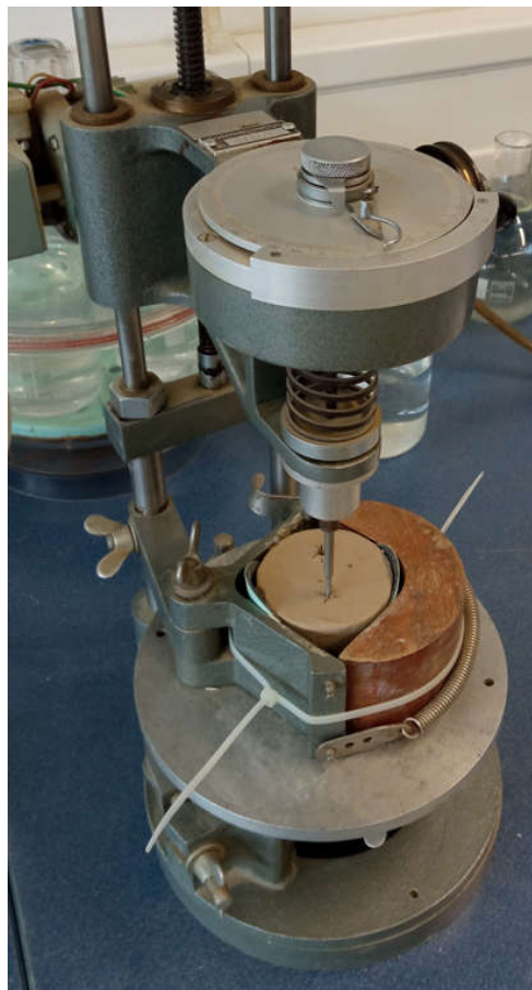
Slika 27.: Laboratorijska krilna sonda, (fotografirano uz dozvolu IGH, 2023.)
