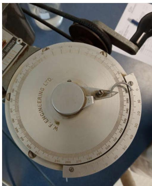
Slika 28.: Laboratorijska krilna sonda-mjerač kuta,
