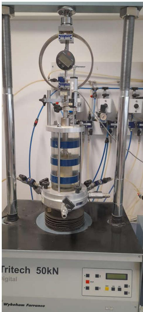
Slika 37.: Preša, troosna čelija, prsten za mjerjenje sile, mjerilo pomaka, (fotografirano uz dozvolu IGH, 2023.)
