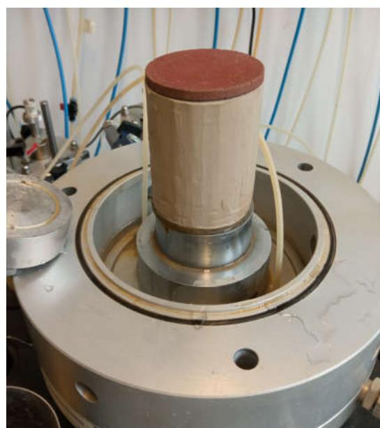
*Slika 49.: Ugradnja uzorka u troosnu čeliju,
