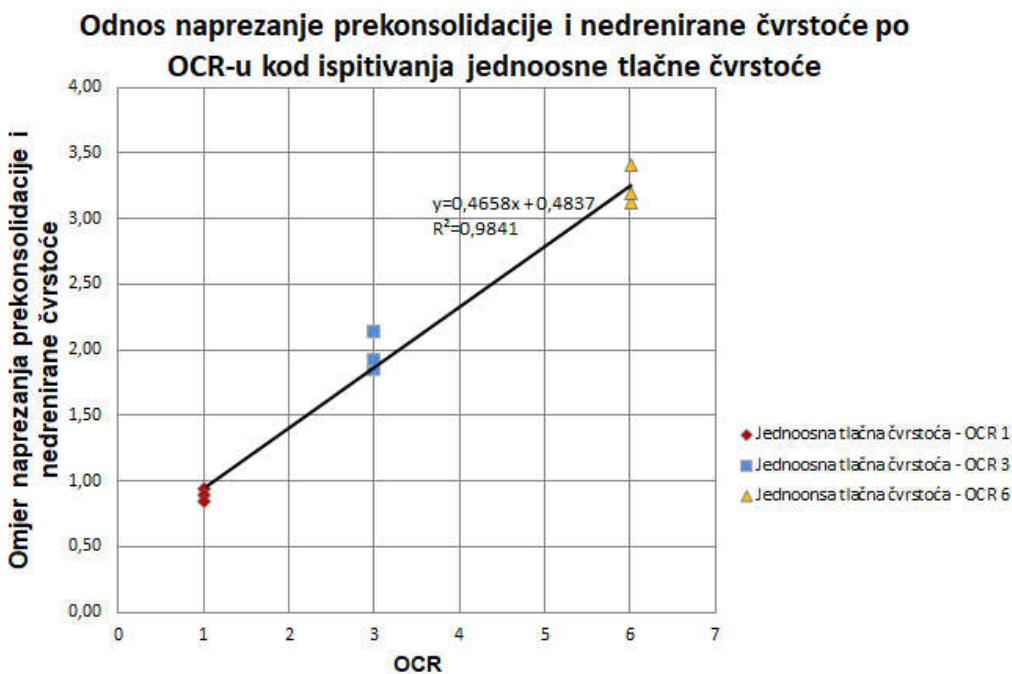
Slika 70.: Dijagram odnosa naprezanja prekonsolidacije i nedrenirane čvrstoće po OCR-u
