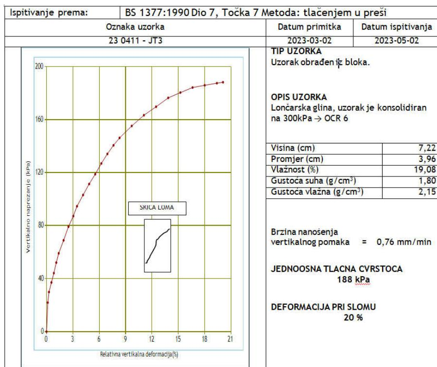
Slika 60.: Izvještaj o ispitivanju jednoosne tlache čvrstoće, (skenirano uz dozvolu IGH, 2023.)
