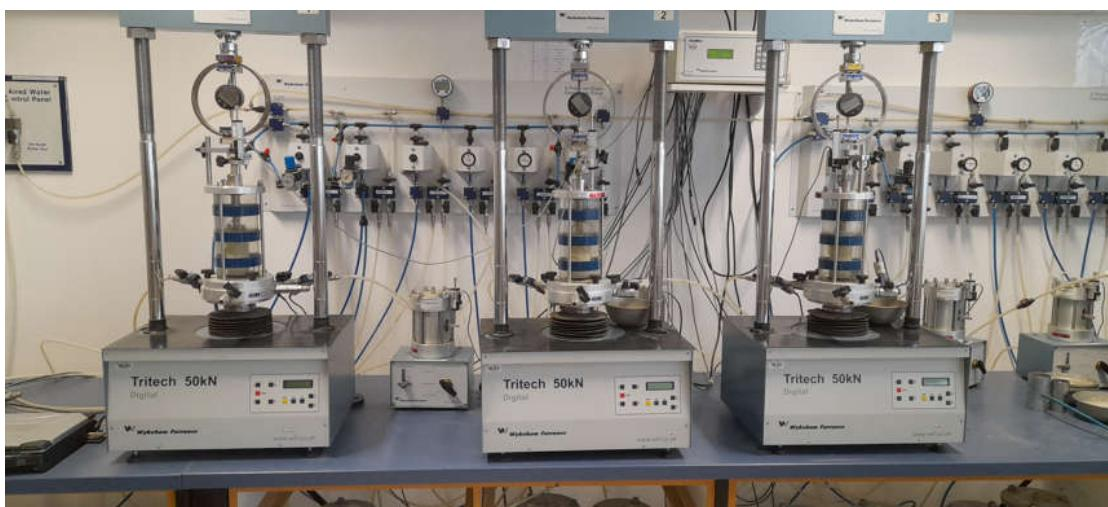
Slika 36.: Sustav za troosno ispitivanje tla,
