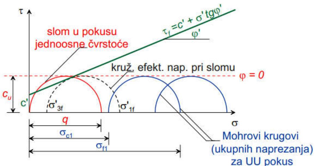
Slika 8. Stanje početnih efektivnih naprezanja, te stanje efektivnih i ukupnih naprezanja pri slomu u UU pokusu (u  $\sigma',\tau$  dijagramu).
