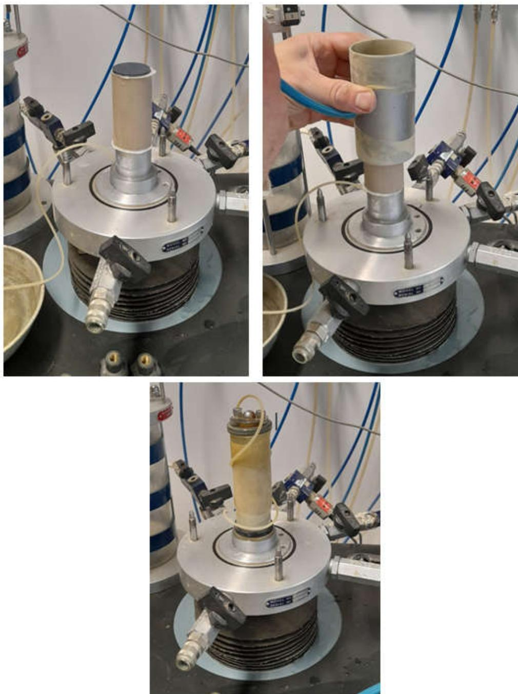
*Slika 41.: Postupak ugradnje uzorka u ćeliju,
