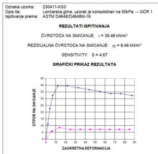
Slika 67.: Izvještaji o ispitivanju u laboratorijskom krilnom sondom,
