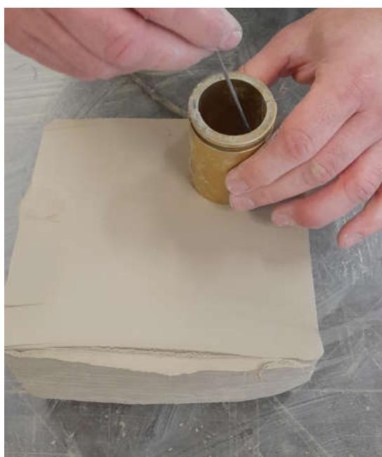
*Slika 30.: Priprema i obrada uzorka za ispitivanje jednoosne tlačne čvrstoće iz bloka, (fotografirano uz dozvolu IGH, 2023.)*
