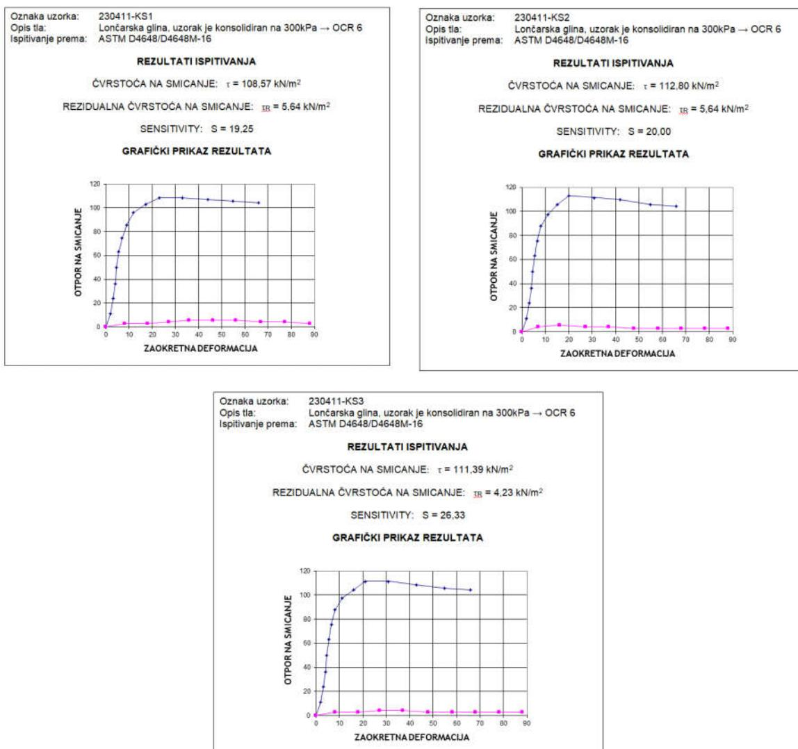
Slika 69.: Izvještaji o ispitivanju u laboratorijskom krilnom sondom,
