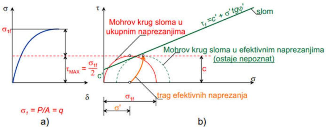
Slika 5. a) dijagram promjene naprezanja s deformacijom u jednoosnom posmiku
