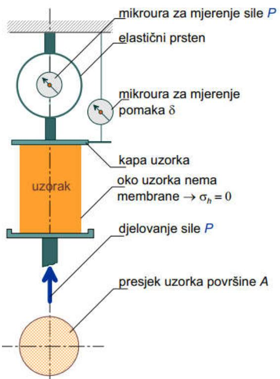
Slika 4. Shema uređaja za jednoosni posmik [4]
