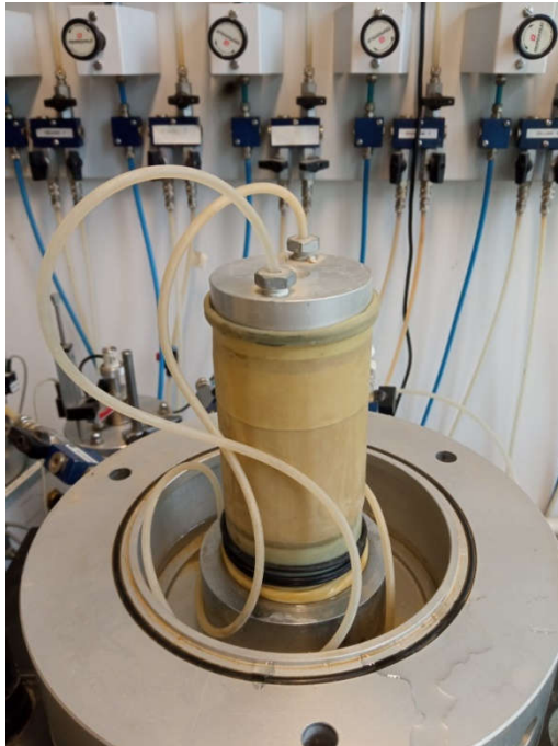
Slika 50.: Postavljanje membrane, O-ringova i gornje kape na uzorak, (fotografirano uz dozvolu IGH, 2023.)
