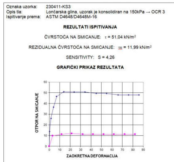
Slika 68.: Izvještaji o ispitivanju u laboratorijskom krilnom sondom,
