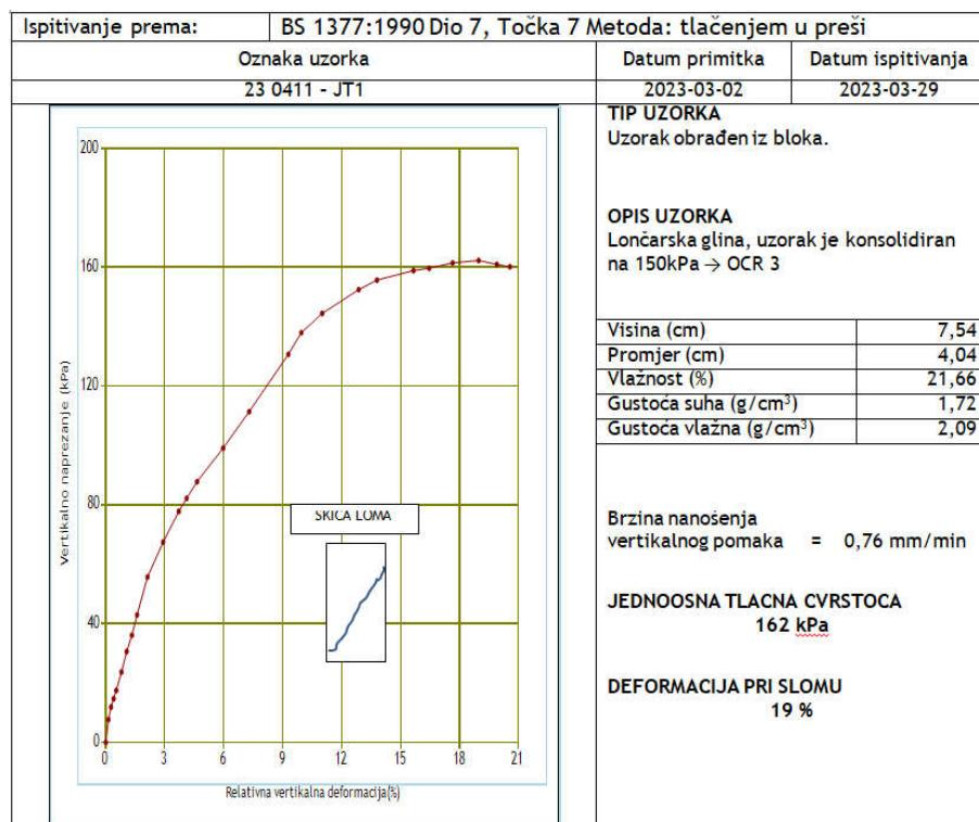
Slika 55.: Izvještaj o ispitivanju jednoosne tlačne čvrstoće,
