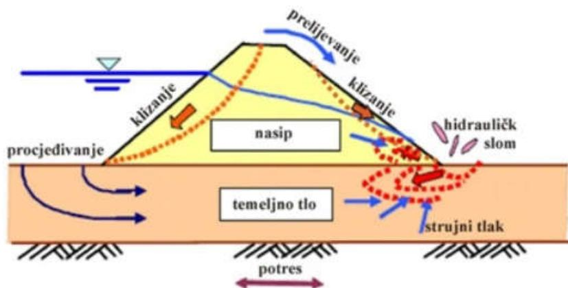
Slika 16. Shematski prikaz kliznih ploha nasutih brana na mekom tlu [11]
