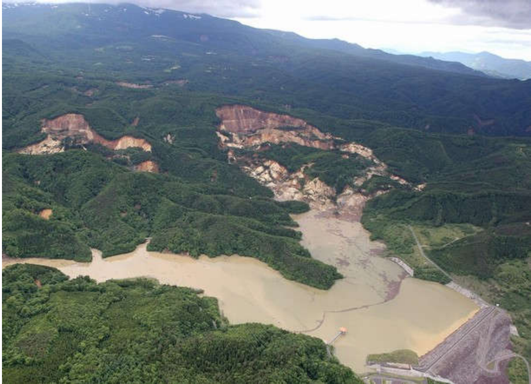
Slika 18.: Klizište u blizini Aratozawa brane u Japanu nastalo kao rezultat potresa Iwate-Miyagi, magnitude 6.9, iz 2008. godine [13]
