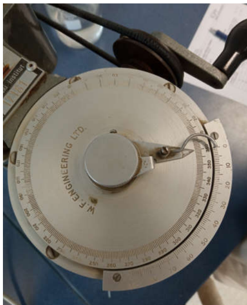
Slika 28.: Laboratorijska krilna sonda-mjerač kuta, (fotografirano uz dozvolu IGH, 2023.)
