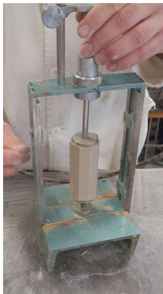
*Slika 40.: Obrada uzorka u trimeru,
