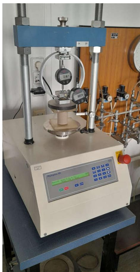
Slika 29: Preša za ispitivanje jednoosne tlačne čvrstoće,
