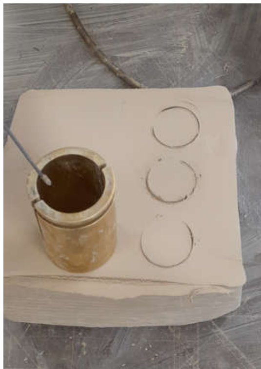
Slika 38.: Priprema i obrada uzorka za ispitivanje u troosnoj ćeliji, (fotografirano uz dozvolu IGH, 2023.)
