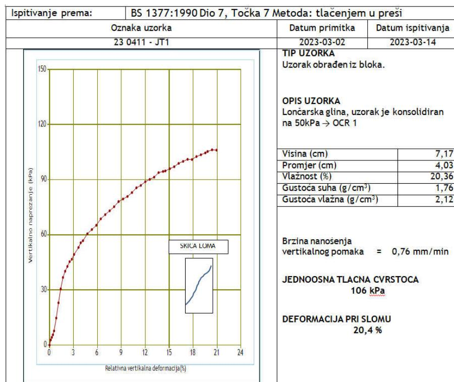
Slika 52.: Izvještaj o ispitivanju jednoosne tlačne čvrstoće,
