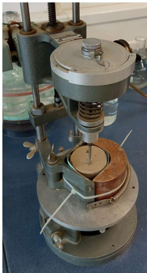
Slika 27.: Laboratorijska krilna sonda,
