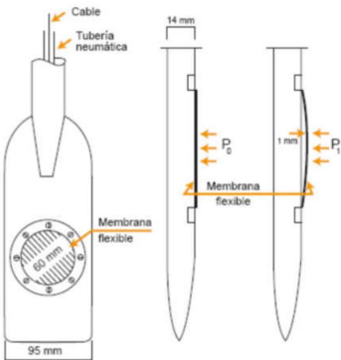
Slika 21.: Dilatometar Marchetti: princip rada, tlakom iz posebnog uređaja tjera se membrana prema van (u tlo), dok se ne poravna sa površinom papučice (tlak  $p_0$ ) i zatim još 1,1 mm (tlak  $p_1$ ) [15]
