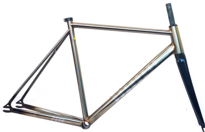
Slika 2.8 Prikaz jednibrzinskog okvira bicikla [67]
