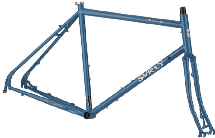
Slika 2.7 Touring okvir s velikim međuosovinskim razmakom [68]
