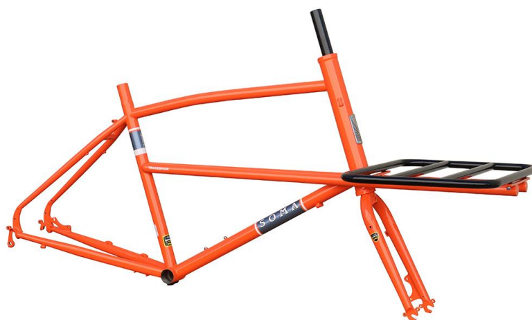
Slika 2.9 Okvir ojačanog teretnog bicikla za transport [69]
