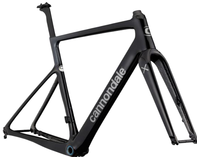
Slika 2.11 Cyclo Cross okvir bicikla [71]
