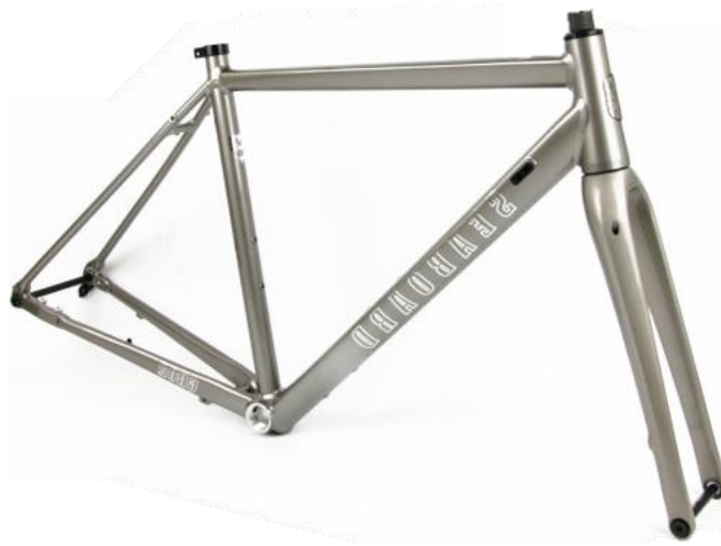
Slika 2.6 Prikaz gravel okvira [67]
