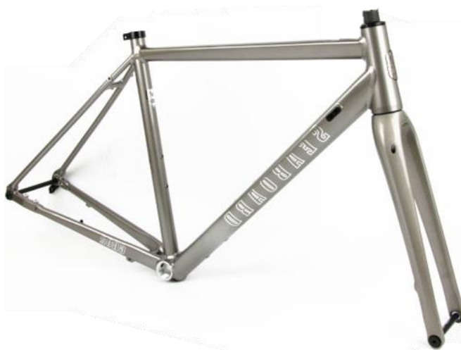
Slika 2.6 Prikaz gravel okvira [67]
