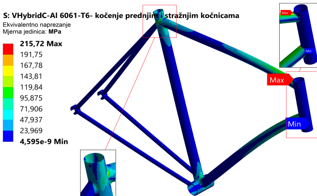
Slika 5.11 FEA analiza naglog kočenja VHybridC okvira s prikazom kritičnih mjesta naprezanja
