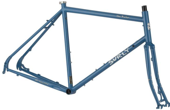
Slika 2.7 Touring okvir s velikim međuosovinskim razmakom [68]
