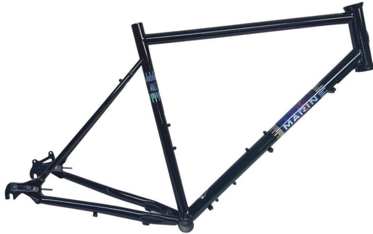
Slika 2.10 Prikaz hibridnog okvira koji posjeduje elemente drugih vrsta okvira [70]
