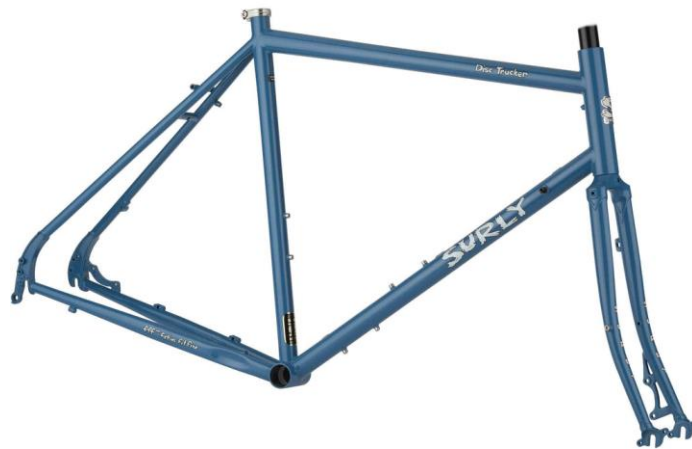
Slika 2.7 Touring okvir s velikim međuosovinskim razmakom [68]
