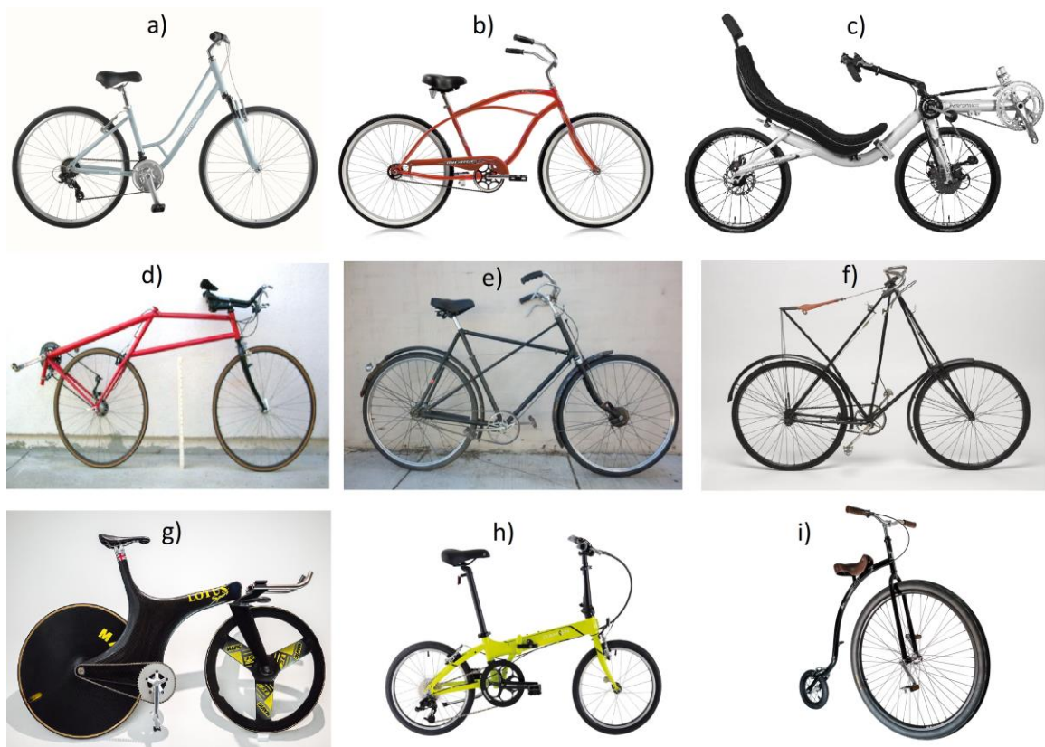
Slika 2.2 Tipovi bicikla s okvirom: a) prolazni okvir, b) konzolni okvir, c) leđni ležeći okvir, d) trbušni ležeći okvir, e) iskrižani okvir, f) rešetkasti okvir, g) monokok okvir, h) preklopni okvir, i) high wheel okvir [56,57,58,59,60,61,62,63,64]
