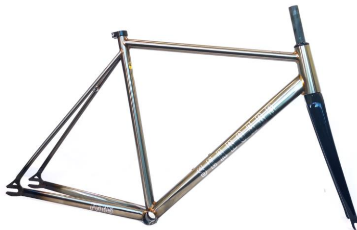
Slika 2.8 Prikaz jednibrzinskog okvira bicikla [67]
