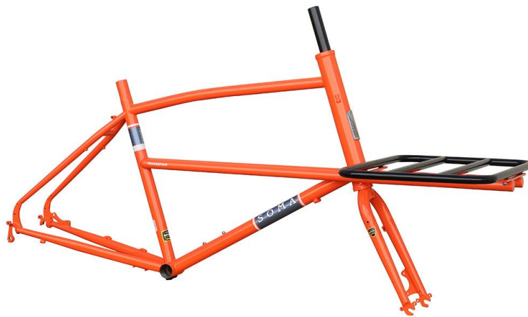
Slika 2.9 Okvir ojačanog teretnog bicikla za transport [69]
