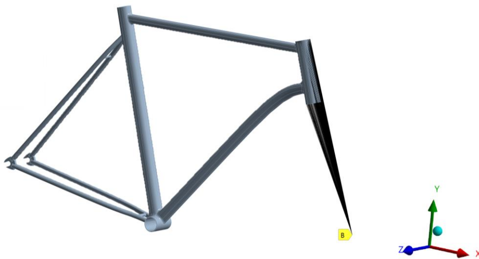
Slika 4.5 Prikaz prednjeg udaljenog oslonca kruto povezanog s modelom VHybrid2
