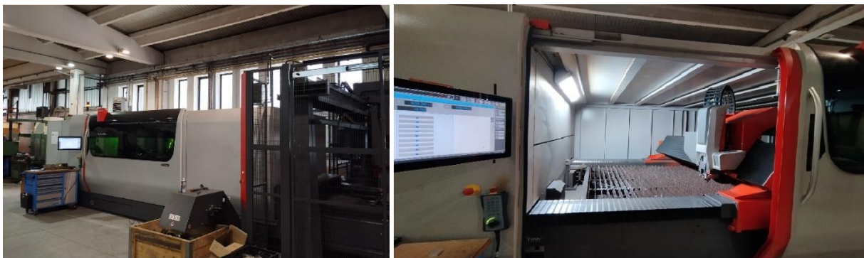
Slika 28: Fiber laser zatvorenog tipa u CNC izvedbi s tri osi (Bystronic Bystar Fiber 3015)
