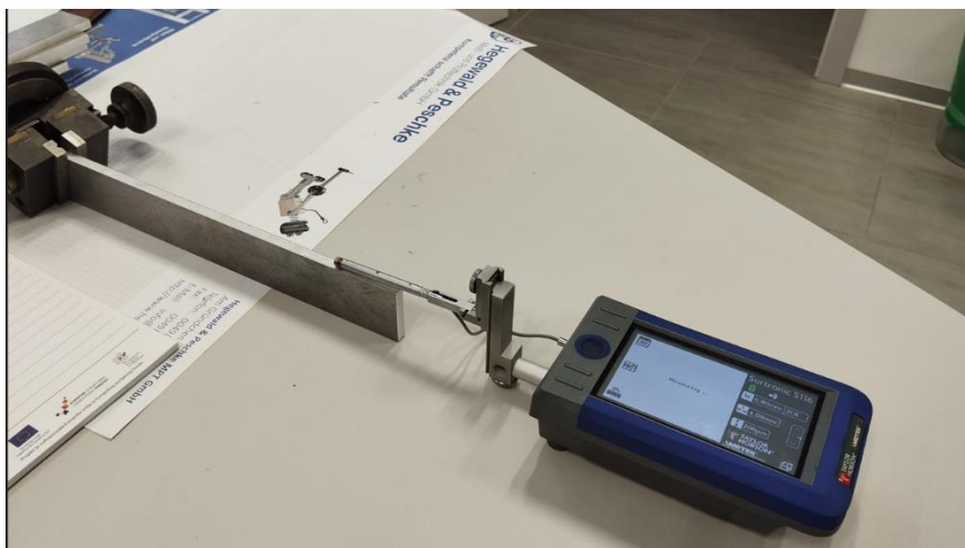
Slika 49: Postupak mjerenja hrapavosti površine
