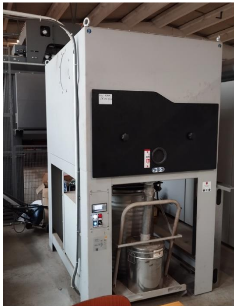
Slika 30: Sustav hlađenja lasera Bystronic Bystar Fiber 3015 izdvojen je od stroja dok su izvor i ostale komponente integrirane
