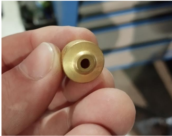
Slika 22: Primjer sapnice (Bystronic Bystar Fiber 3015)
