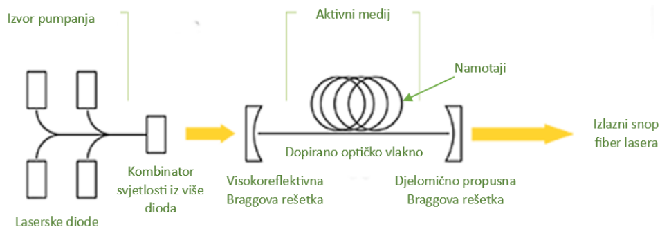
Slika 12: Shematski prikaz rezonatora fiber lasera [9]
