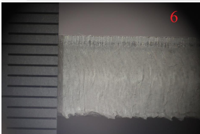
Slika 62: Izgled reznih površina uzoraka 9, 5 i 6 - vidljiva razlika u količini troske
