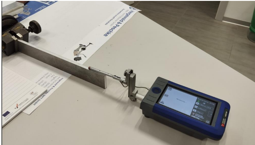
Slika 49: Postupak mjerenja hrapavosti površine
