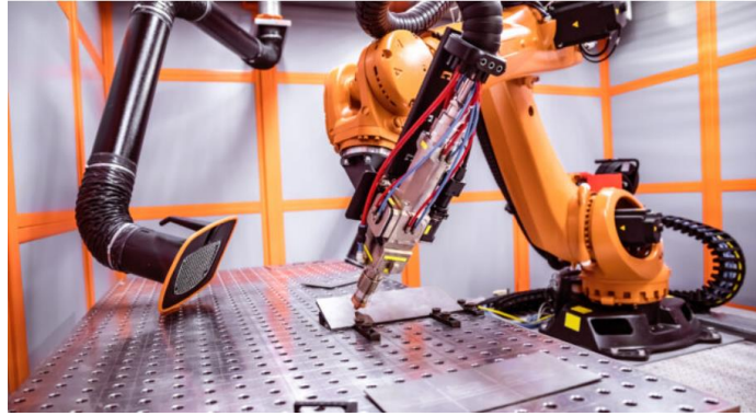
Slika 26: Robotski sustav za lasersko rezanje [26]
