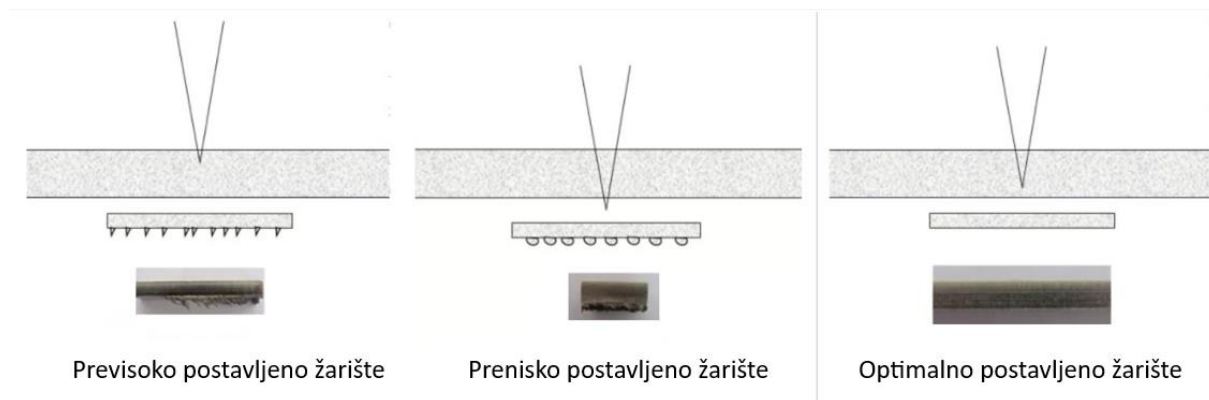
Slika 20: Utjecaj položaja žarišta na kvalitetu rezne površine [18]
