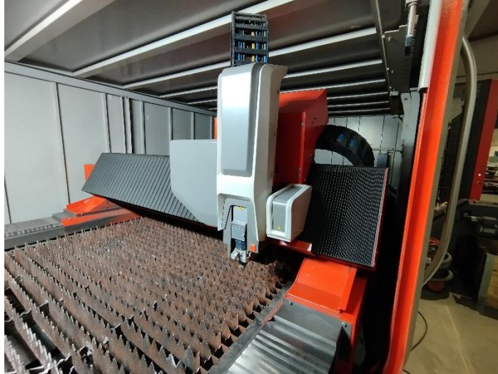
Slika 32: Radni prostor i radna glava stroja
