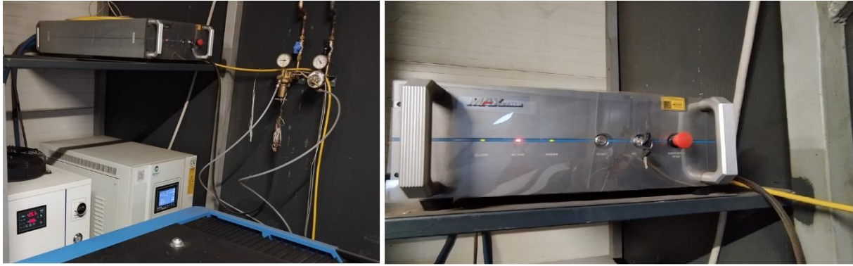
Slika 29: Sustav hlađenja i laserski izvor izdvojeni od stroja (Senfeng SF3015G)
