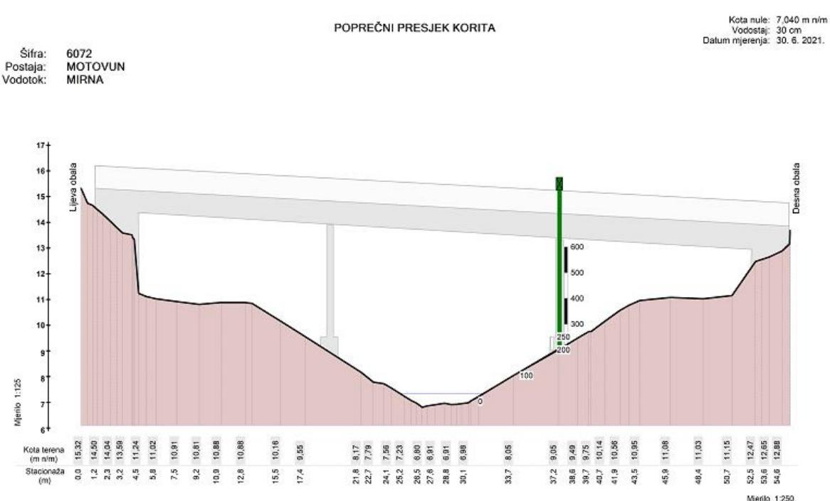
*Slika 23:* Poprečni presjek profila kod Portonskog mosta [22]
