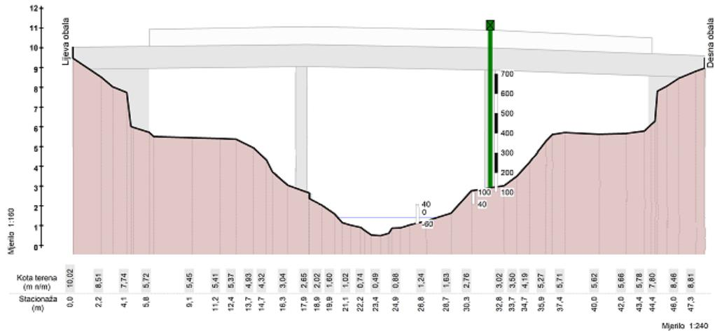
Slika 20: Poprečni presjek profila kod Motovuna [22]
