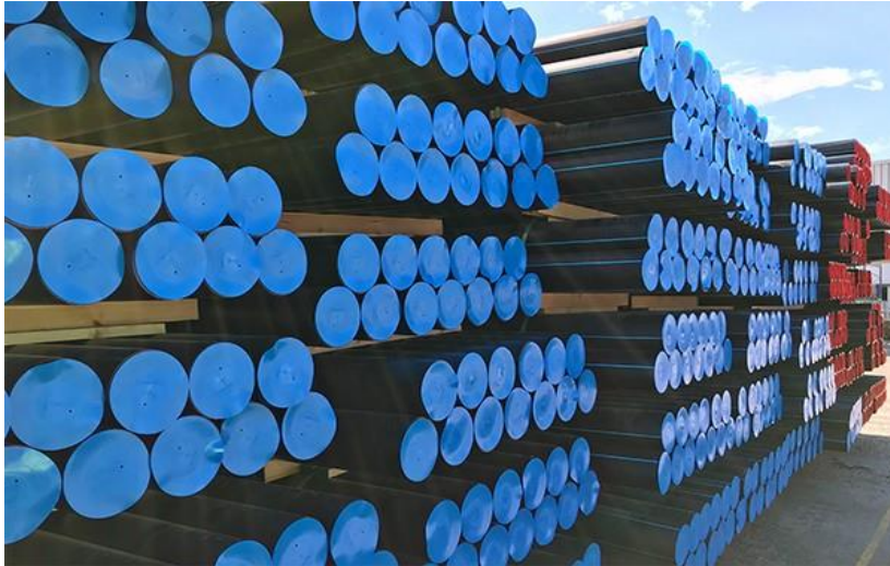
Slika 6: skladištenje paletiziranih PE cijevi [10]
