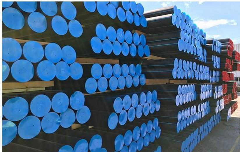
Slika 6: skladištenje paletiziranih PE cijevi [10]
