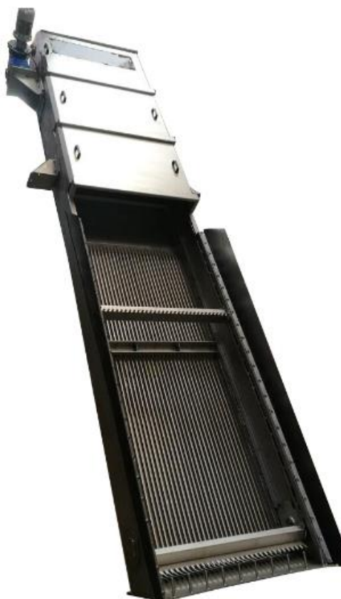
Slika 20. Automatska gruba rešetka [26]
