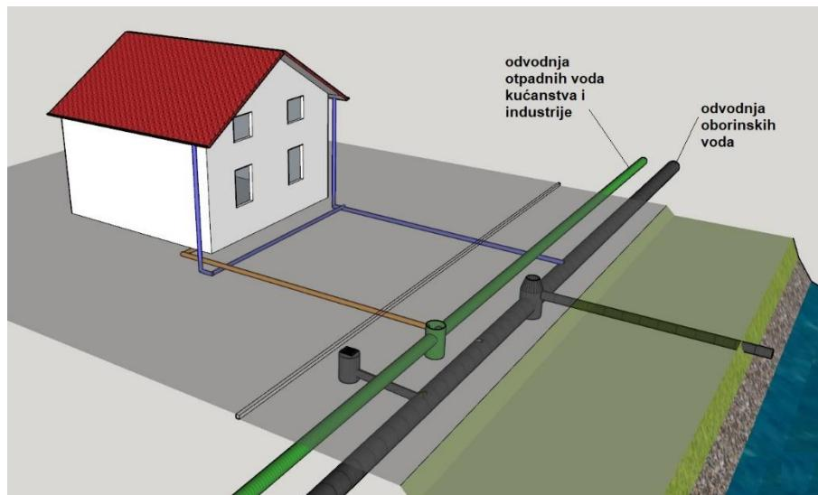
Slika 3. Razdjelni sustav odvodnje
