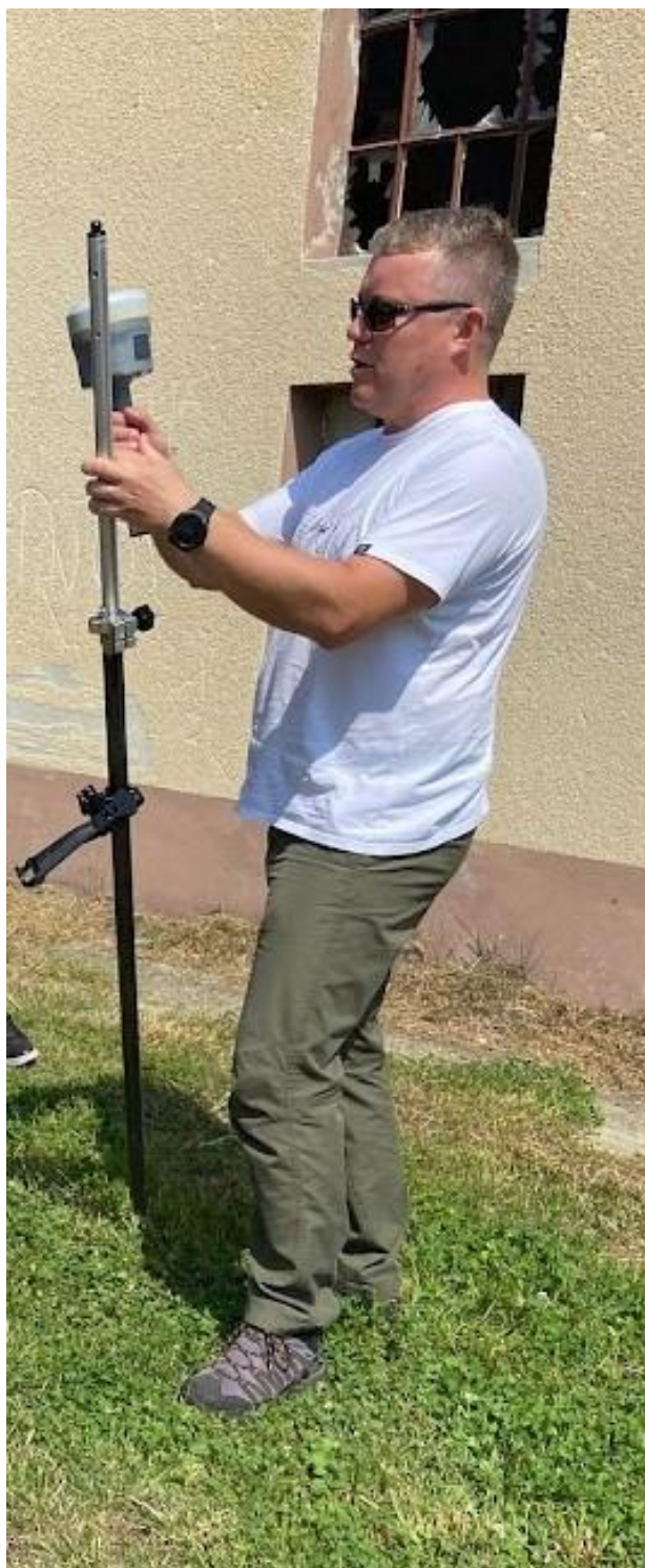
Slika 68. Sastavljanje GNSS uređaja
