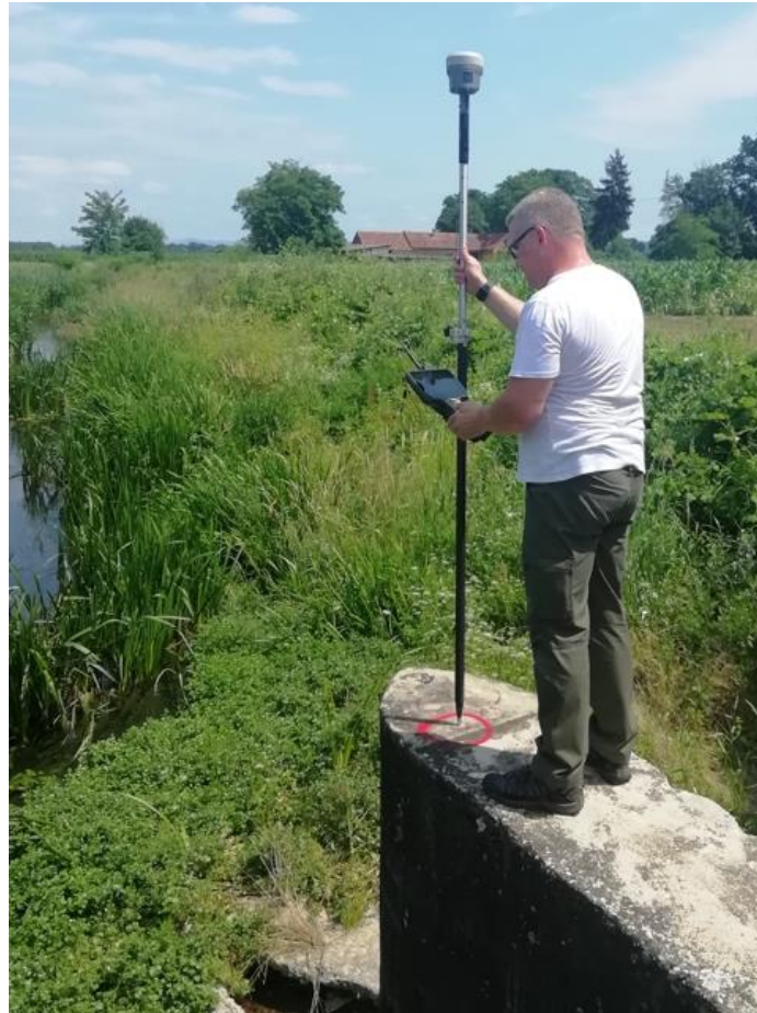
Slika 72. Označena točka – primjer na zapornici
