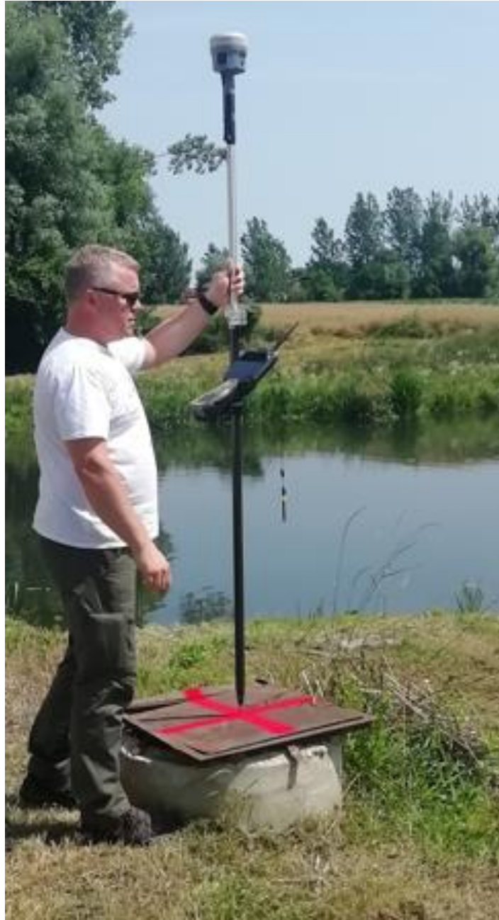
Slika 71. Označena točka – primjer na poklopcu revizijskog okna
