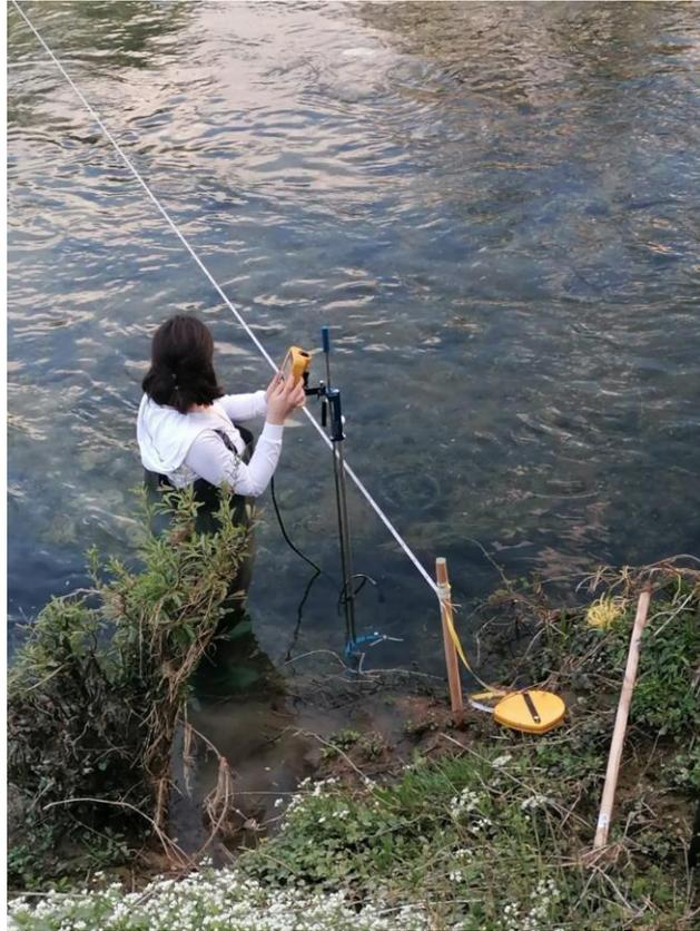
Slika 16. Postupak mjerenja Flow Tracker2 ultrazvučnim uređajem [8]
