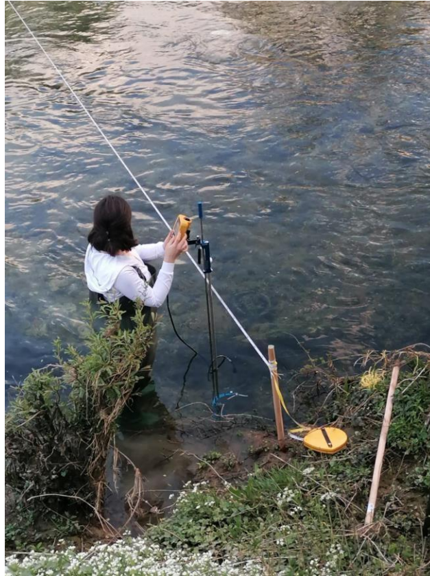
Slika 16. Postupak mjerenja Flow Tracker2 ultrazvučnim uređajem [8]
