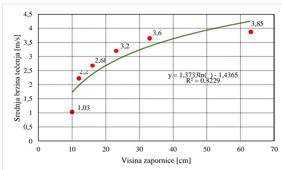
Slika 34. Ovisnost brzine tečenja o visini zapornice [8]
