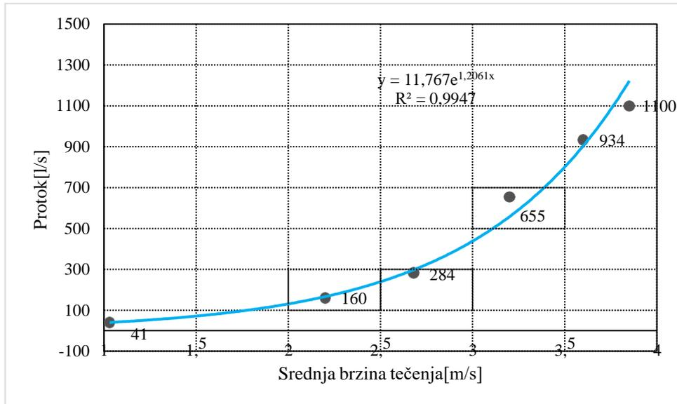
Slika 35. Ovisnost protoka i brzine tečenja [8]
