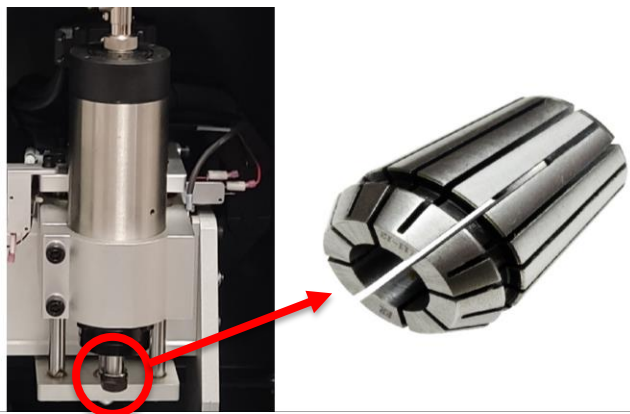
Slika 19. Stezna čahura ER11
