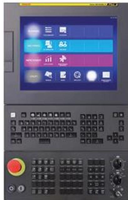
Slika 16. Upravljačka jedinica Fanuc 30i [19]
