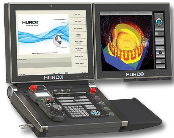
Slika 17. Upravljačka jedinica Hurco MAX 5 [20]
