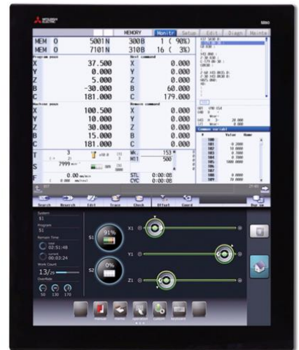
Slika 19. Upravljачka jedinica Mitsubishi Electric M800 [22]
