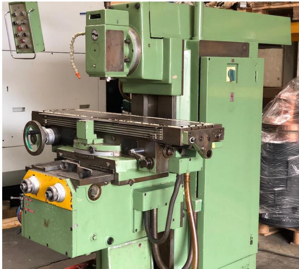
Slika 2. Primjer klasične glodalice [5]
