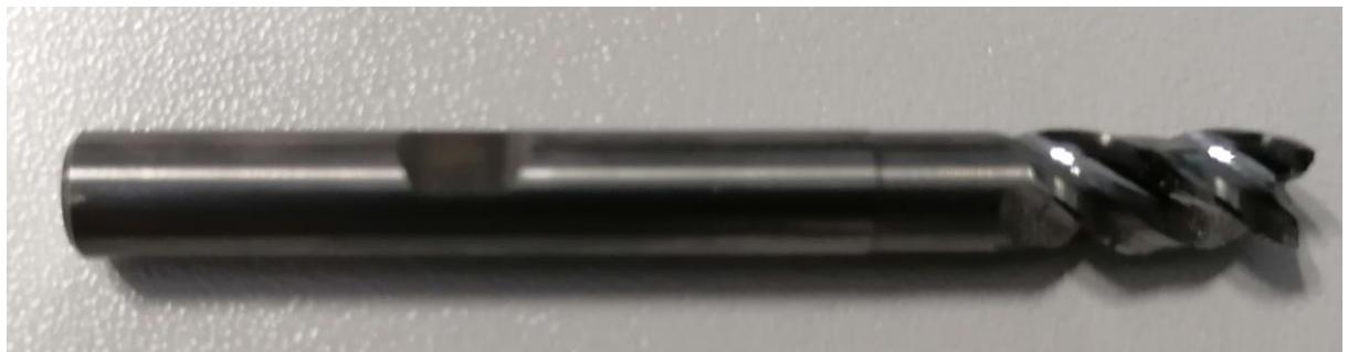
Slika 36. Glodalo  $\varnothing 6$  mm
