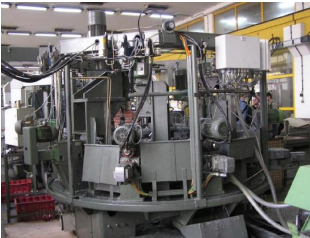
Slika 7. Primjer rotofer linije [10]
