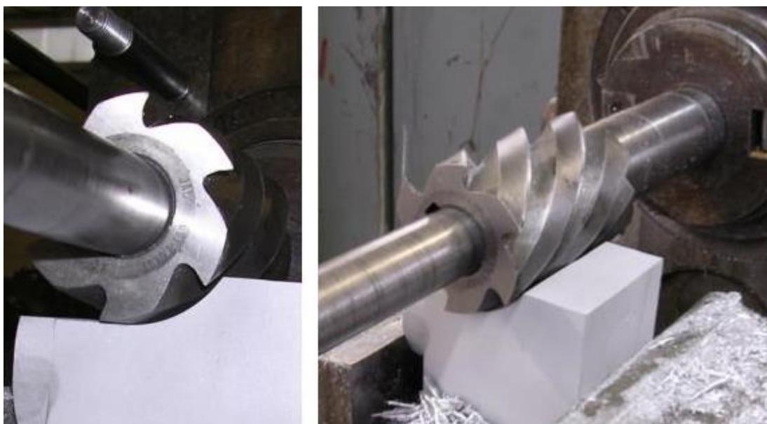
*Slika 9. Istosmjerno glodanje [12]*
