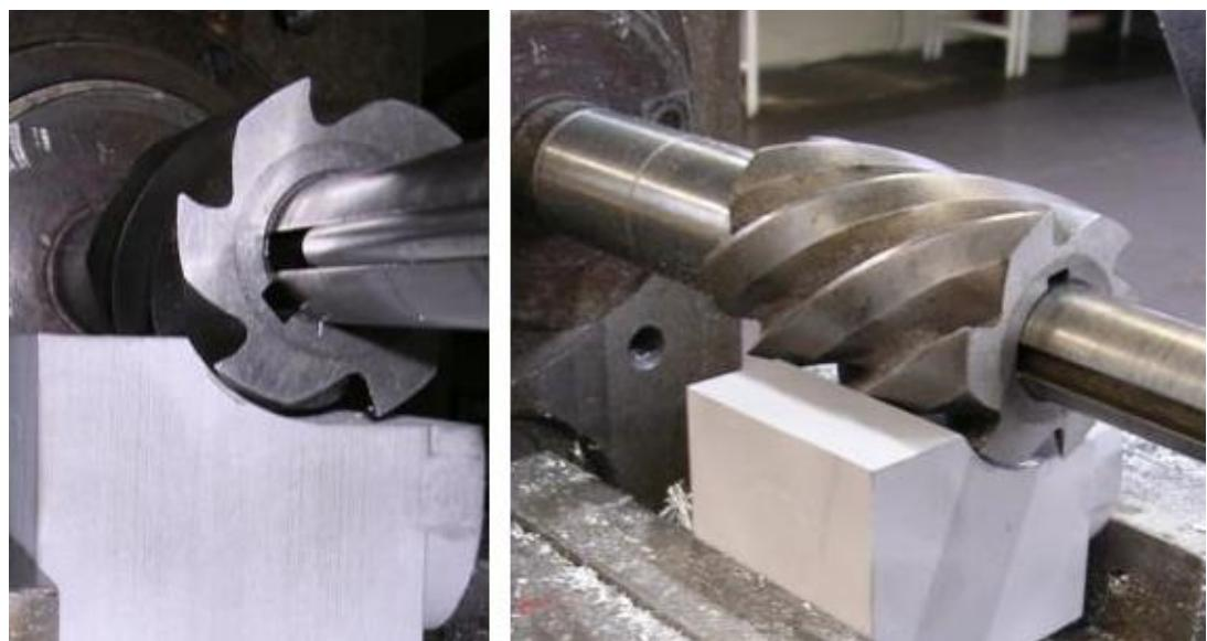
*Slika 10. Protusmjerno glodanje [12]*
