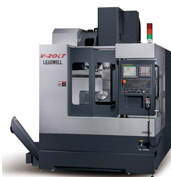
Slika 4. Primjer glodaćeg obradnog centra [7]
