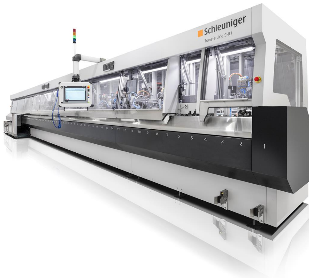
Slika 8. Primjer transfer linije[11]
