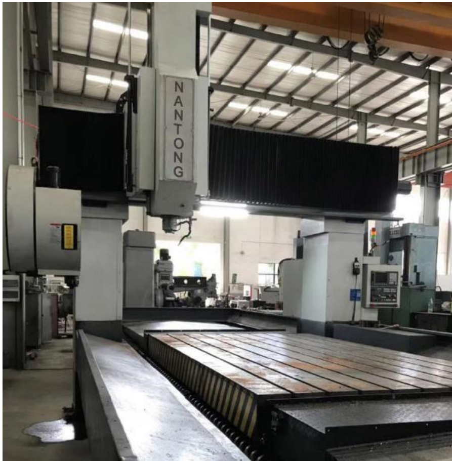
Slika 3. Primjer vertikalne portalne NU glodalice sa tri upravljanje osi [6]
