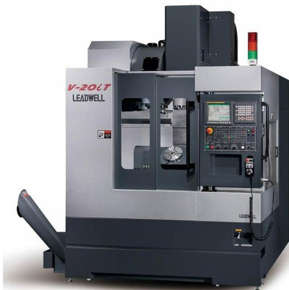
*Slika 4. Primjer glodaćeg obradnog centra [7]*
