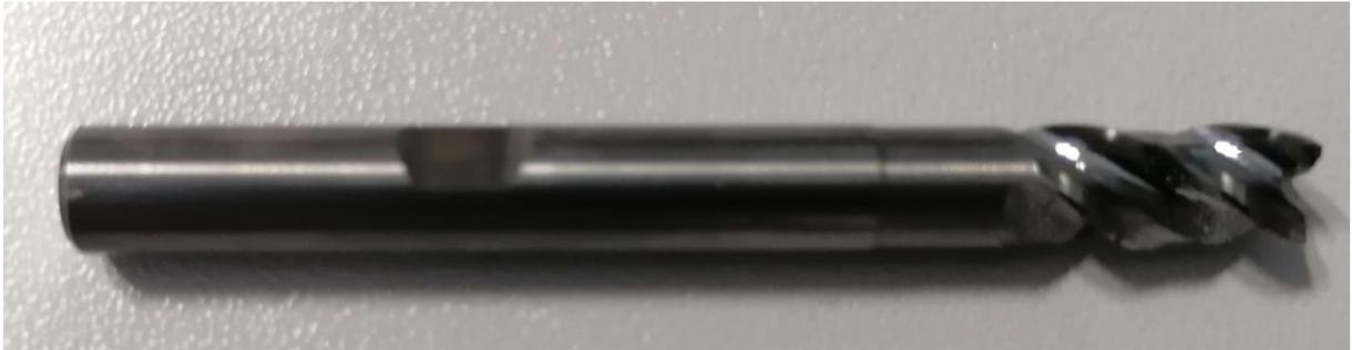
*Slika 36. Glodalo  $\phi 6$  mm*
