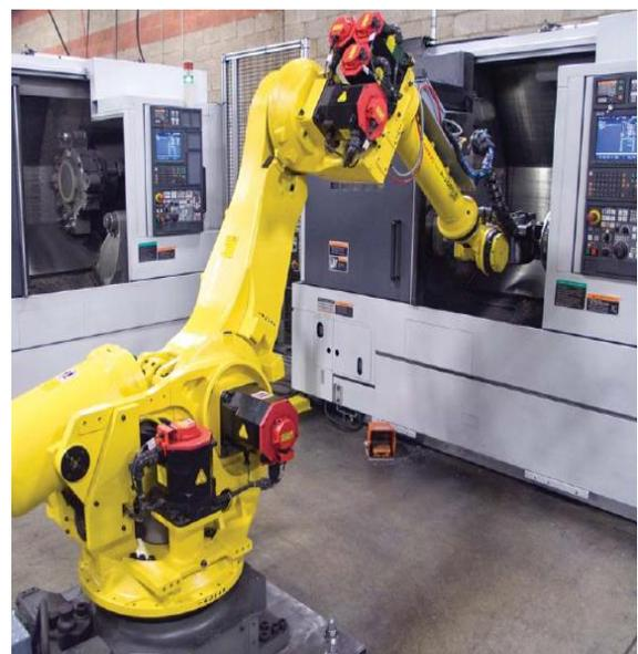
*Slika 5. Primjer fleksibilne tokarske obradne ćelije s robotom [8]*
