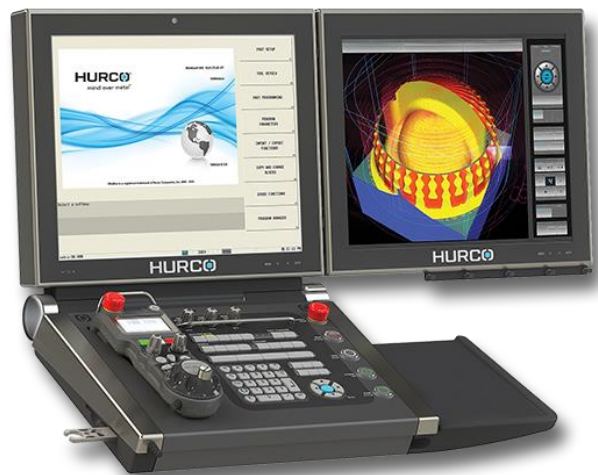
Slika 17. Upravljačka jedinica Hurco MAX 5 [20]
