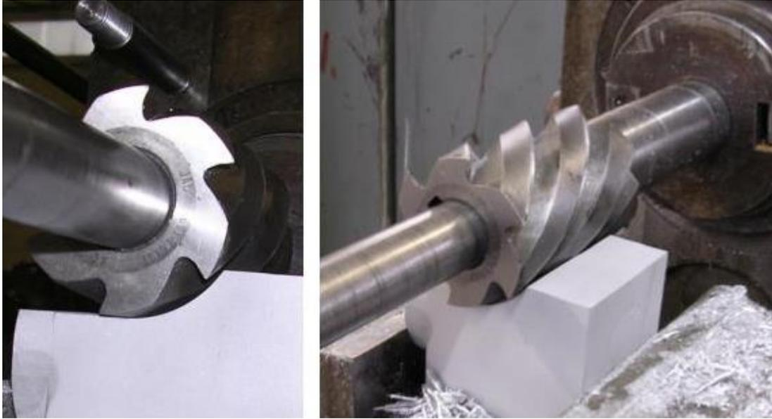
*Slika 9. Istosmjerno glodanje [12]*
