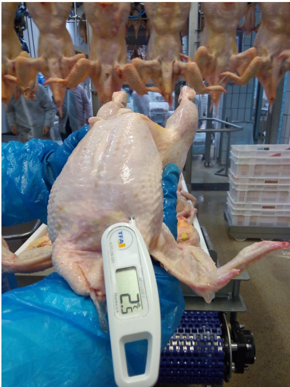
Slika 3. Provjera temperature pilećih trupova ubodnim termometrom.
