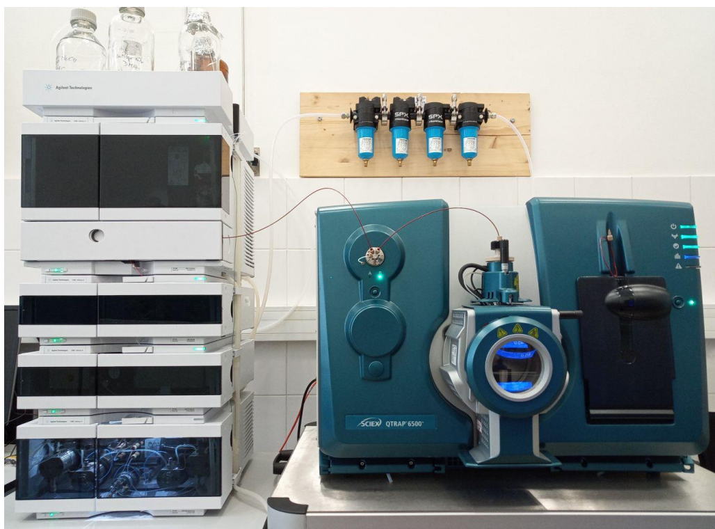
Slika 2. LC-MS/MS sustav (Agilent 1290 Infinity II – Sciex QTRAP 6500+), izvor:
