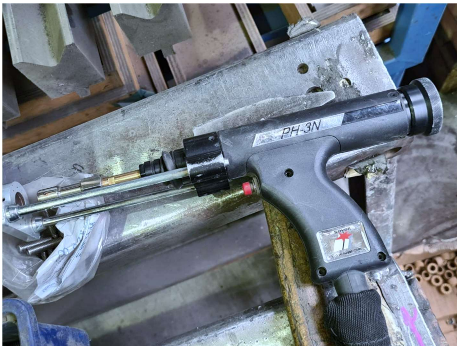
Slika 4.3. Pištolj za zavarivanje SOYER PH-3N
