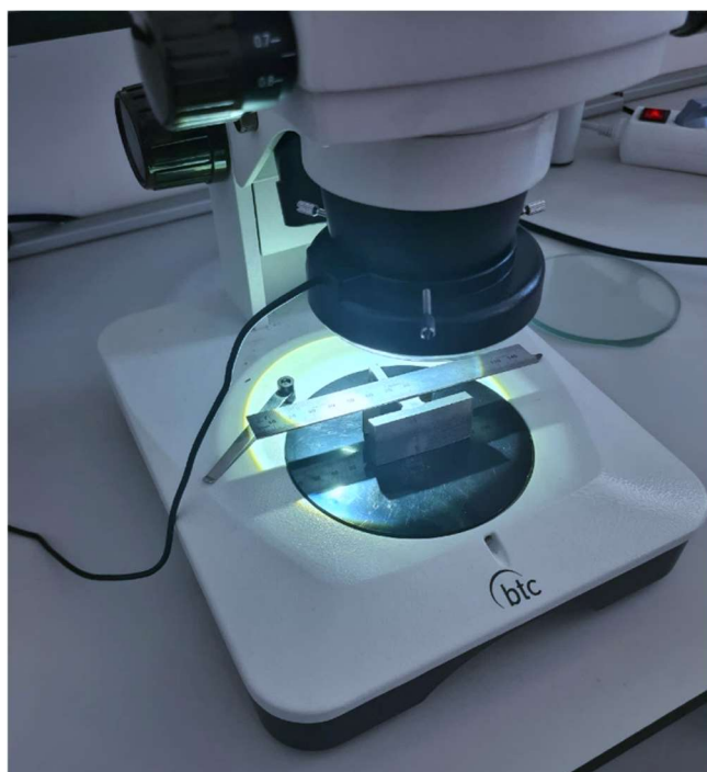
Slika 4.23. Svjetlosni mikroskop BTC (lijevo) te prikaz mjerenja karakteristične dimenzije zavora makro izbruska svornjaka (desno)
