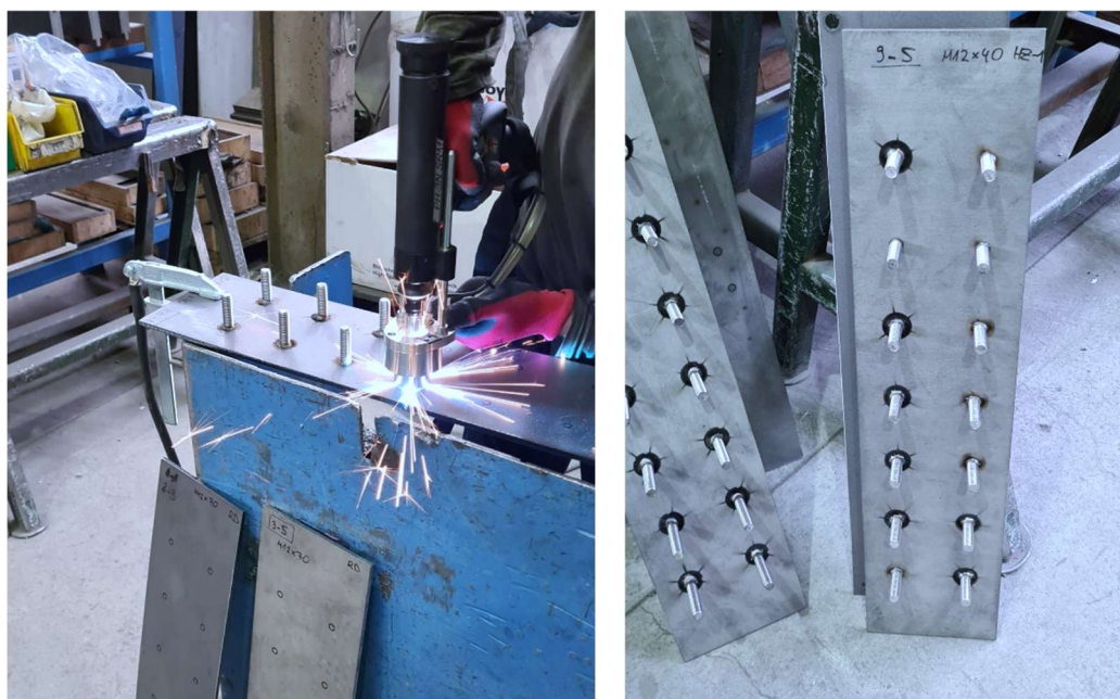
Slika 4.14. Tijek SRM postupka zavarivanja (lijevo) te izgled zavarenih ispitnih ploča (desno)
