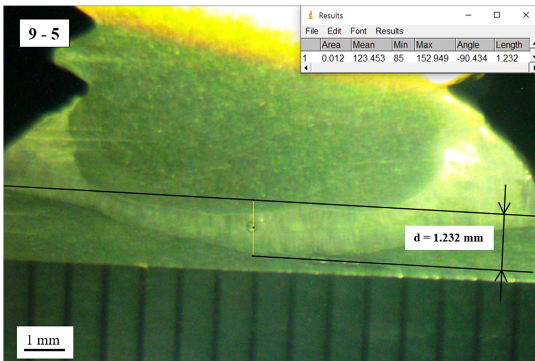
Slika 4.29. Mjerenje penetracije zavora makro izbruska uzorka 9-5
