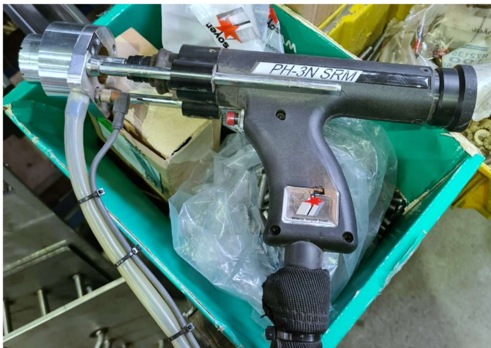
Slika 4.4. Pištolj za zavarivanje SOYER PH-3N SRM
