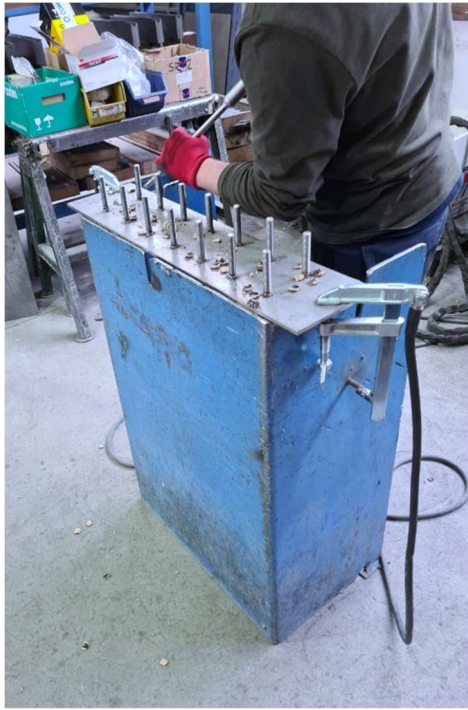
Slika 4.12. Mehaničko čišćenje i uklanjanje keramičkih prstenova nakon završenog zavarivanja
