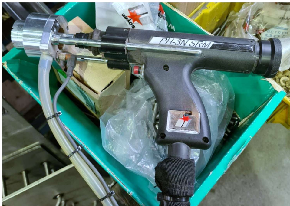
Slika 4.4. Pištolj za zavarivanje SOYER PH-3N SRM
