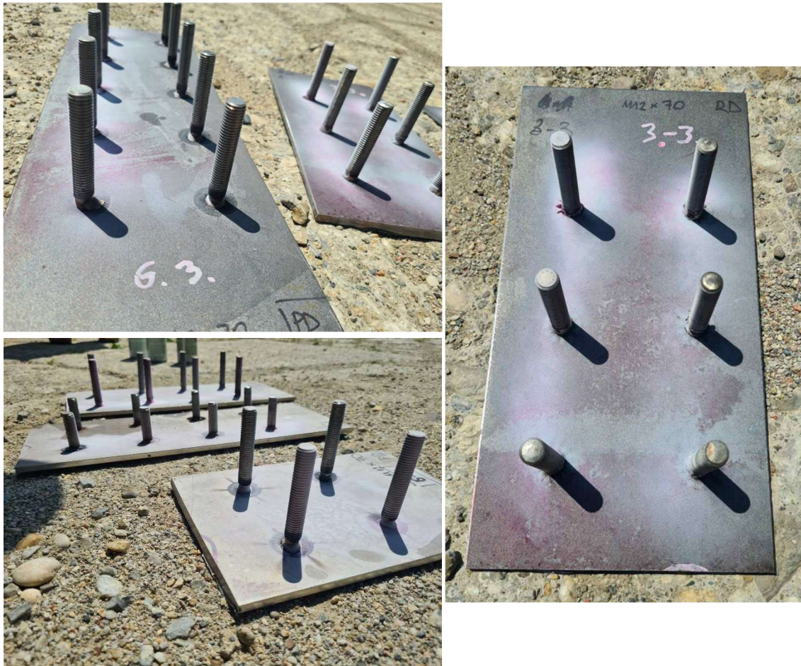
Slika 4.36. Stvaranje eventualnih penetracijskih indikacija
