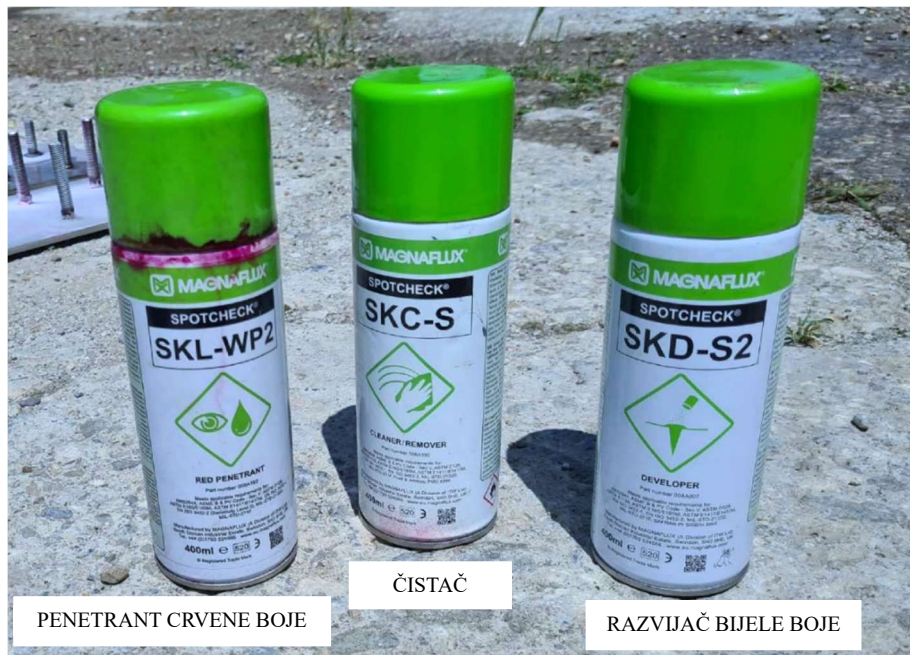
Slika 4.34. Sredstva penetracijske metode ispitivanja
