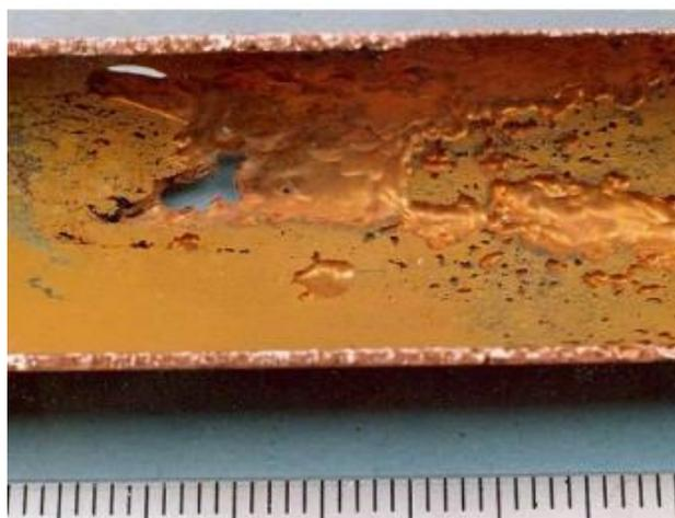
Slika 15 Erozijska korozija bakrene cijevi [10]
