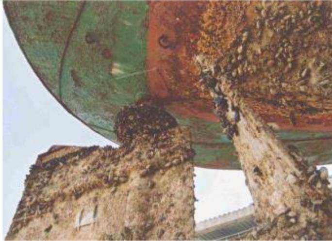
*Slika 21 Obraštanje podvodnog dijela brodskog trupa [13]*
