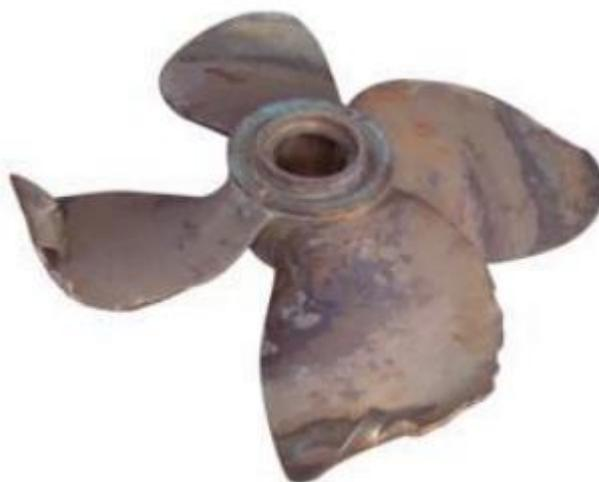
*Slika 18 Kavitacijska korozija brodskog propelera [4]*
