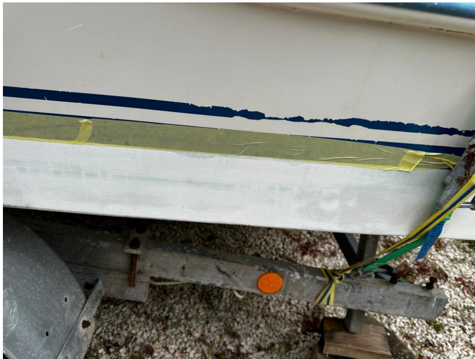
Slika 26 Svježe nanesen protuobraštajni premaz na plovilo [2]
