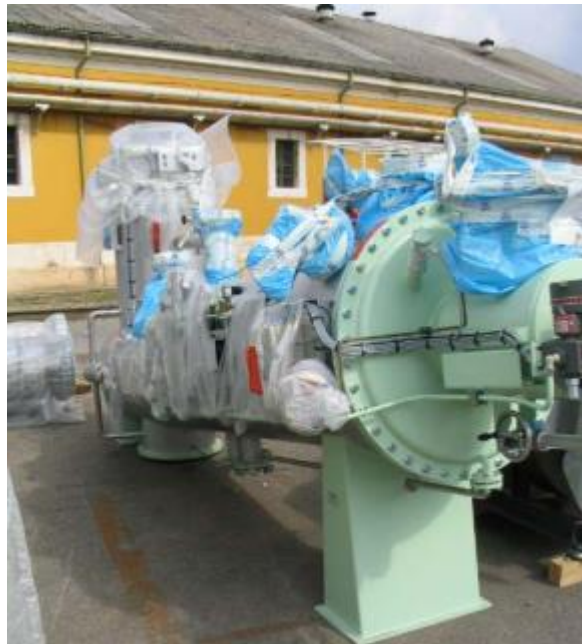
Slika 29 Zaštita brodske opreme najlonskom folijom [21]
