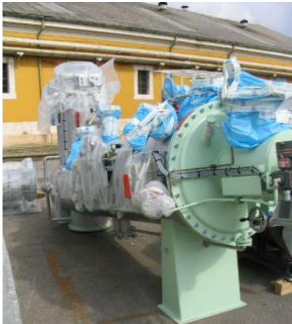
Slika 29 Zaštita brodske opreme najlonskom folijom [21]
