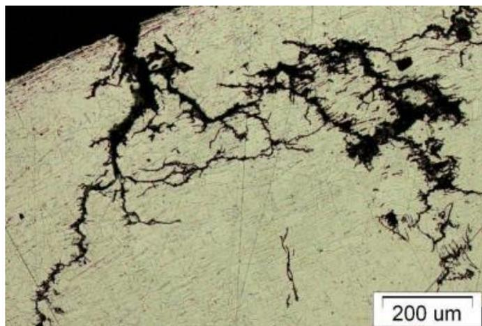
Slika 14 Mikrostrukturni snimak transkristalne napetosne korozije [10]
