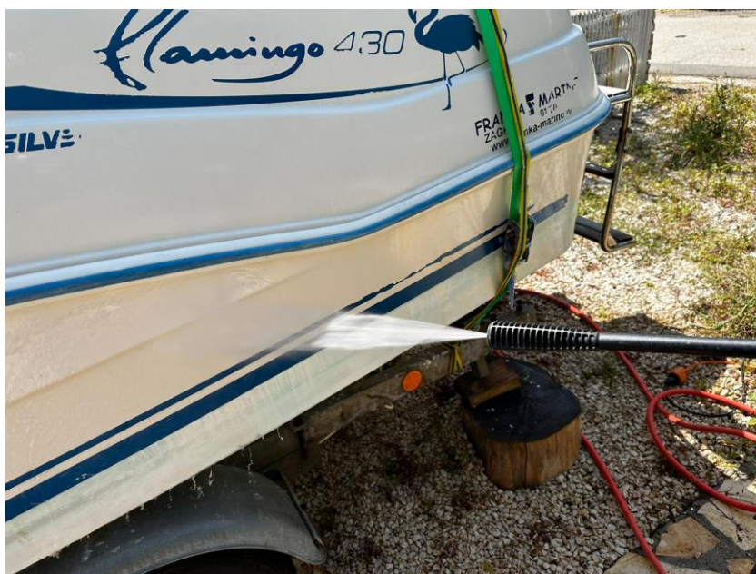
Slika 24 Mokra priprema površine mlazom vode pod visokim tlakom [2]
