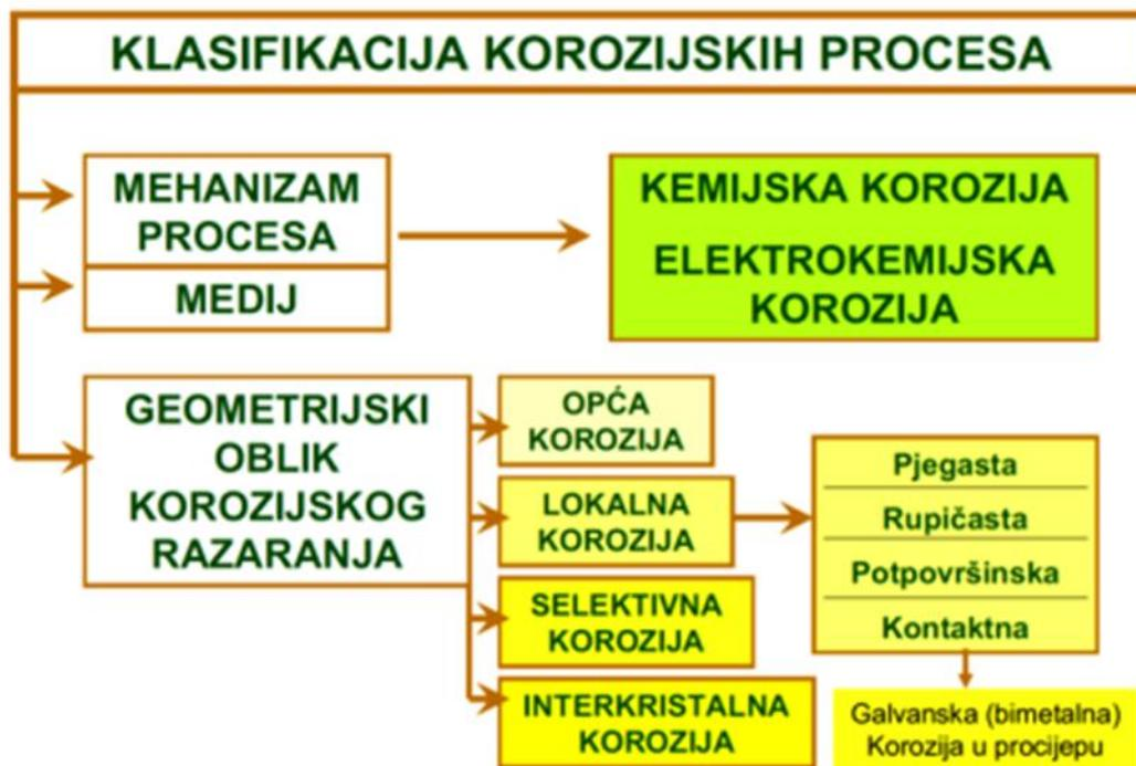
Slika 5 Klasifikacija korozijskih procesa [9]
