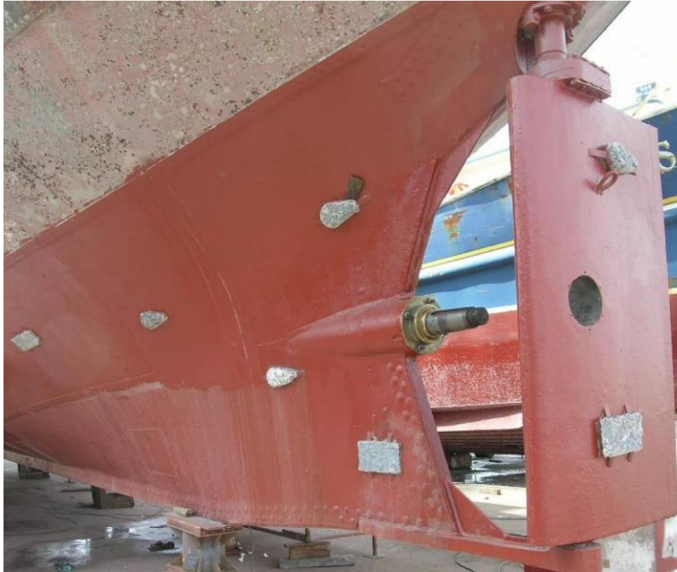
Slika 31 Zaštita brodskog trupa protektorskim anodama od cinka [13]
