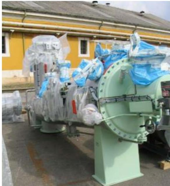
*Slika 29 Zaštita brodske opreme najlonskom folijom [21]*
