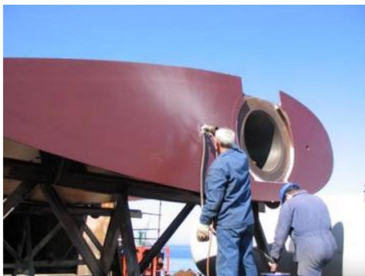
*Slika 28 Primjena inhibitora korozije za zaštitu unutrašnjosti lista [21]*
