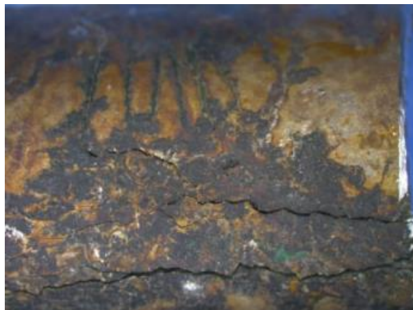
Slika 13 Transkristalna napetosna korozija [10]
