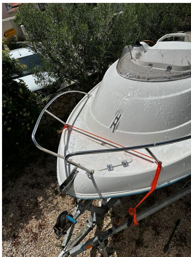
Slika 24 Mokra priprema površine mlazom vode pod visokim tlakom [2]
