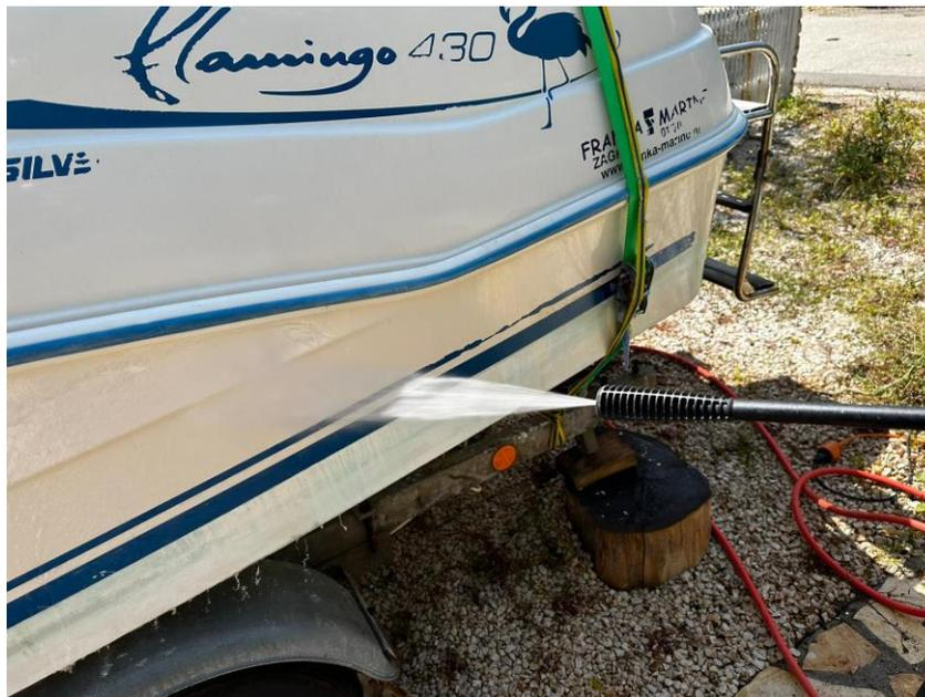
*Slika 24 Mokra priprema površine mlazom vode pod visokim tlakom [2]*
