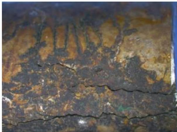
Slika 13 Transkristalna napetosna korozija [10]
