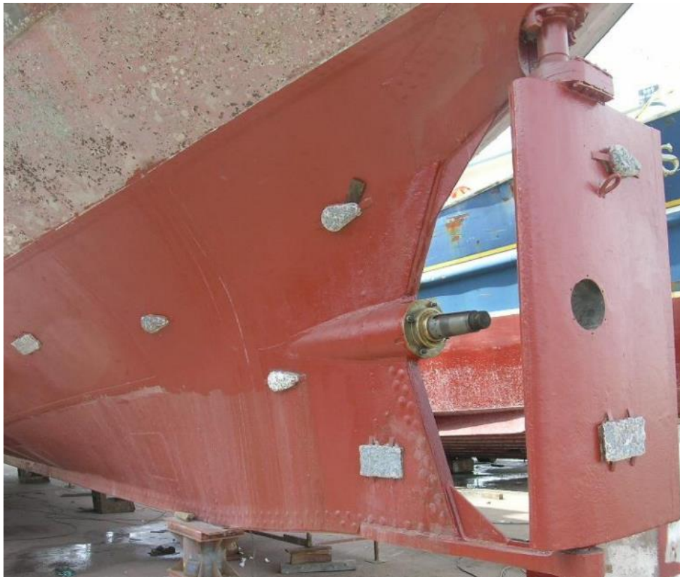
Slika 31 Zaštita brodskog trupa protektorskim anodama od cinka [13]
