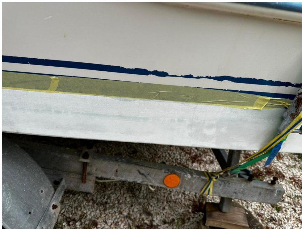
Slika 26 Svježe nanesen protuobraštajni premaz na plovilo [2]
