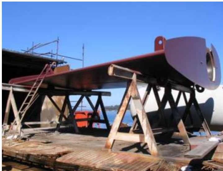
Slika 27 Primjena inhibitora korozije za zaštitu unutrašnjosti lista kormila [21]
