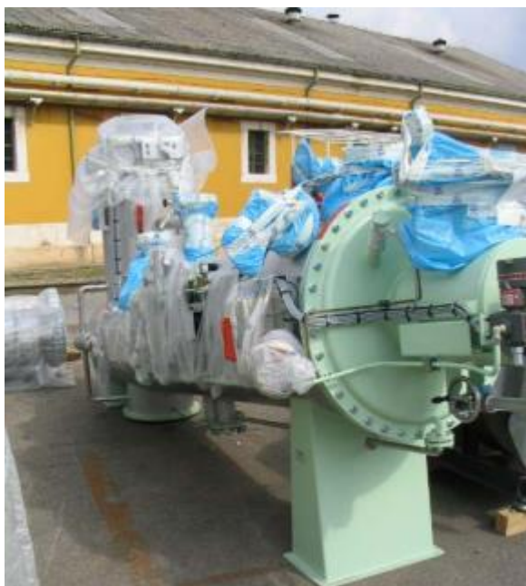
Slika 29 Zaštita brodske opreme najlonskom folijom [21]
