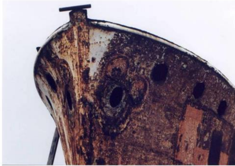
Slika 7 Opća korozija na čeličnoj oplati trupa broda [10]
