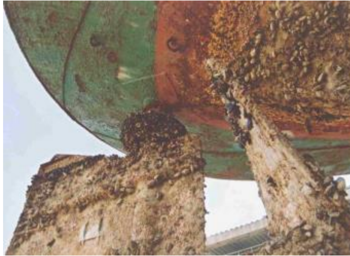
Slika 21 Obraštanje podvodnog dijela brodskog trupa [13]
