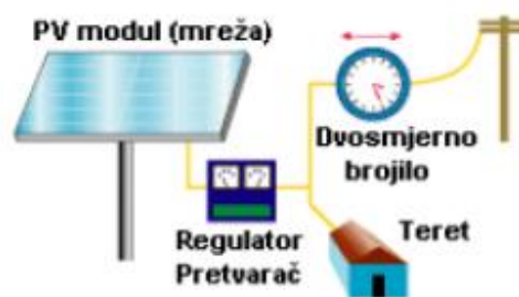
Dodatni izvor energije na mreži (on-grid)
