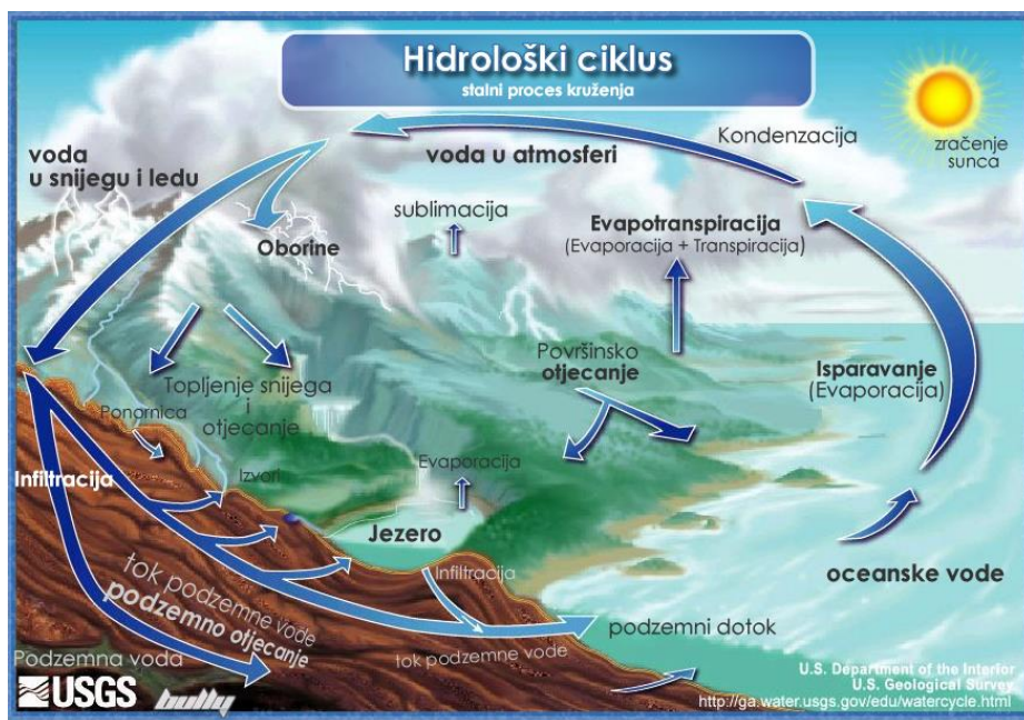
Slika 3 Kruženje vode u zemljnom sustavu
