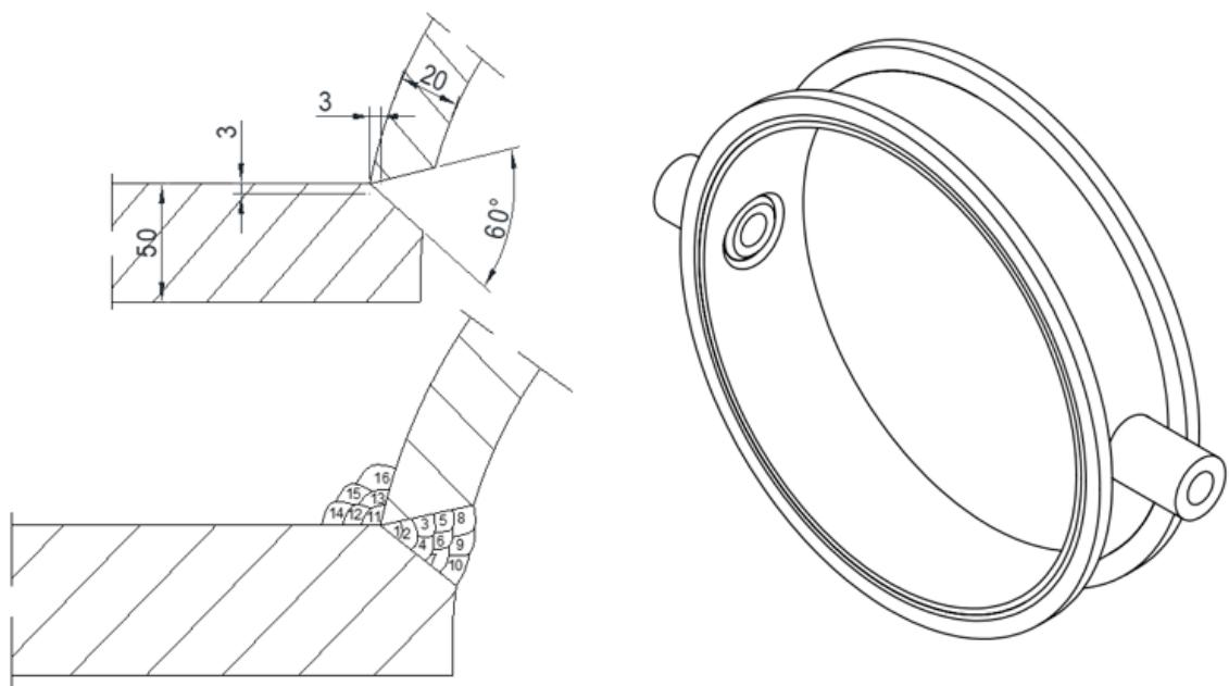
Slika 60 Vrsta spoja i mesta prolaza zavar na spoju između kućišta i pogonskih prirubnica [Prilog 6]
