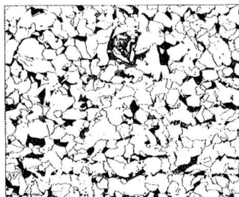
Slika 6 Mikrostruktura općeg konstrukcijskog čelika s 0,1%C [6]
