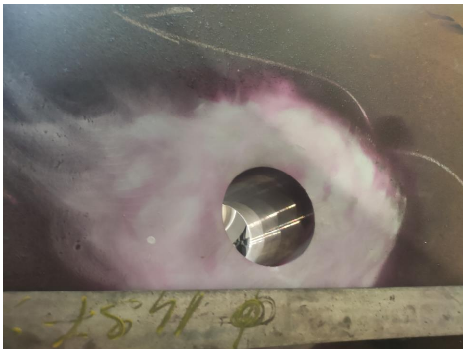
Slika 64 Ispitivanje penetrantom zavarenog spoja plašta i nabe
