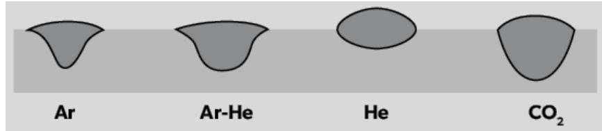
Slika 22 Utjecaj zaštitnog plina na izgled zavarenog spoja [22]
