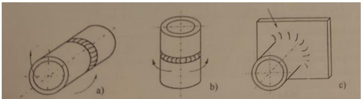
*Slika 42. Položaji i oznake zavarivanja za cijevi prema normi HRN EN ISO 6947:2012 (Zavarivanje i srodnji postupci – Položaj pri zavarivanju) [29]*
