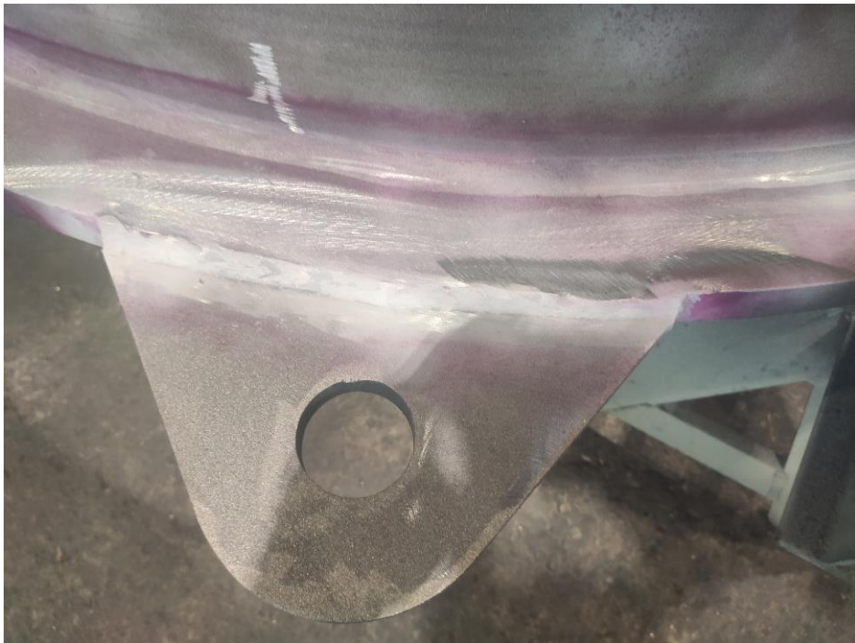
Slika 64 Ispitivanje penetrantom zavarenog spoja plašta i nabe
