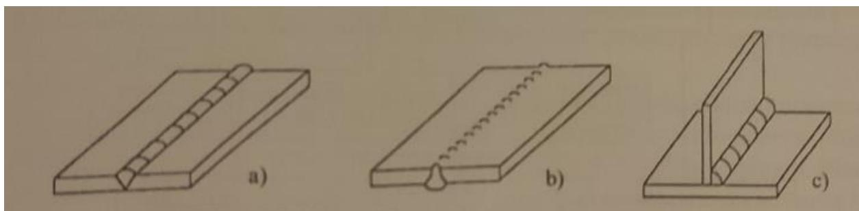
Slika 41. Položaji i oznake za zavarivanje limova prema normi HRN EN ISO 6947:2012 (Zavarivanje i srođni postupci – Položaj pri zavarivanju) [29]
