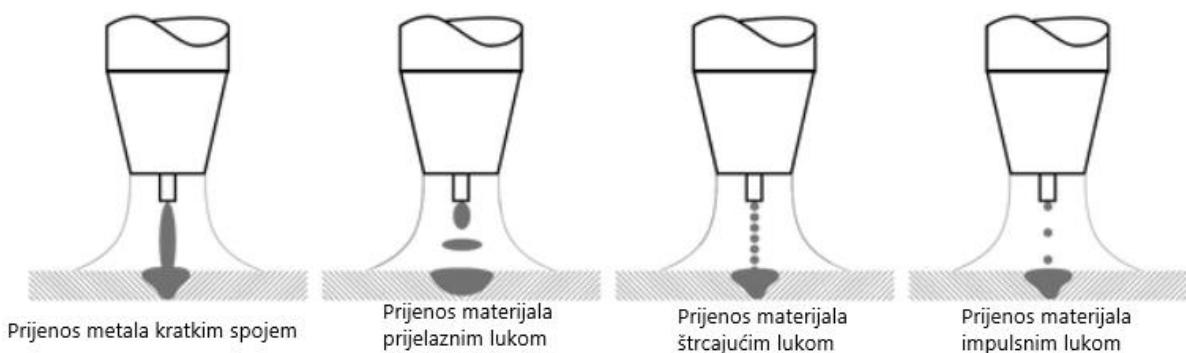
Slika 13 Vrste prijenosa materijala kod MIG/MAG postupka zavarivanja [15]
