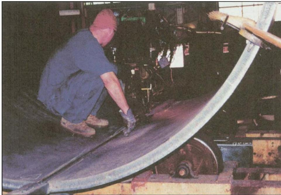
*Slika 26 Postupak mehaniziranog zavarivanja pod praškom [20]*
