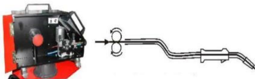
Slika 16 Sustav za dovođenje žice „push“ [17]
