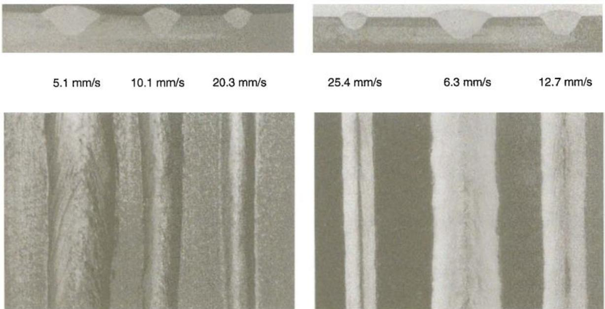
Slika 36 Utjecaj brzine zavarivanja na konačni zavareni spoj [20]
