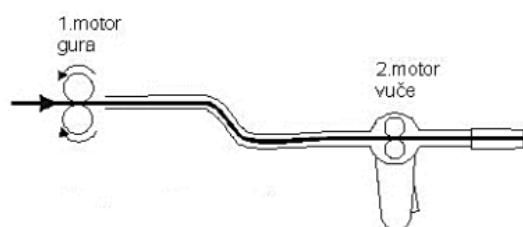
Slika 17 Sustav za dovođenje žice „push-pull“ [17]
