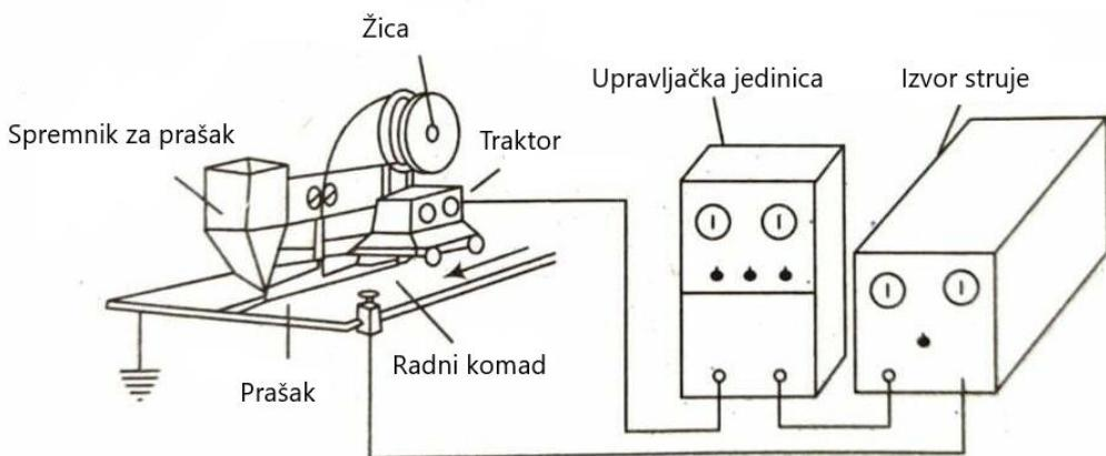
Slika 30 Shematski prikaz EPP zavarivanja s traktorom [24]
