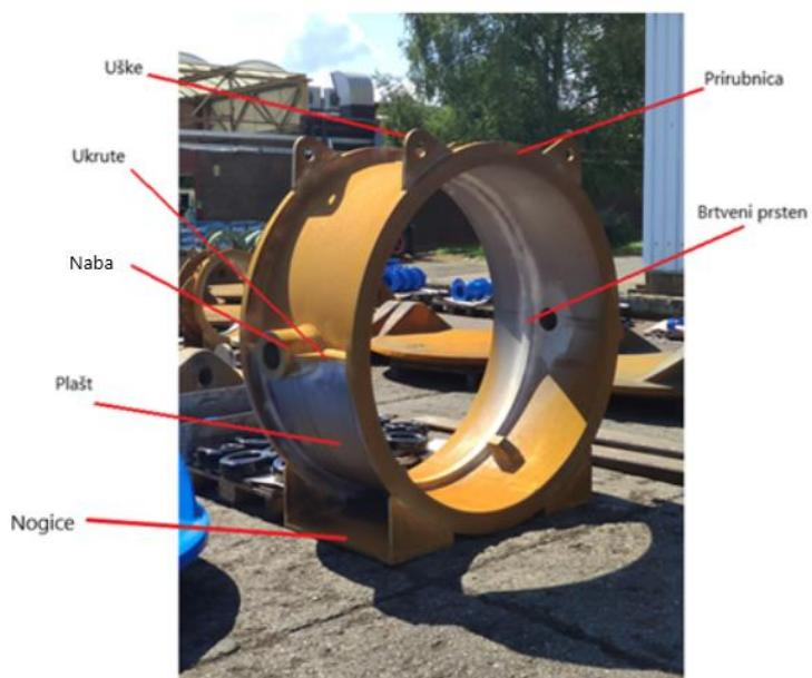
Slika 49 Kućište leptirastog zatvarača
