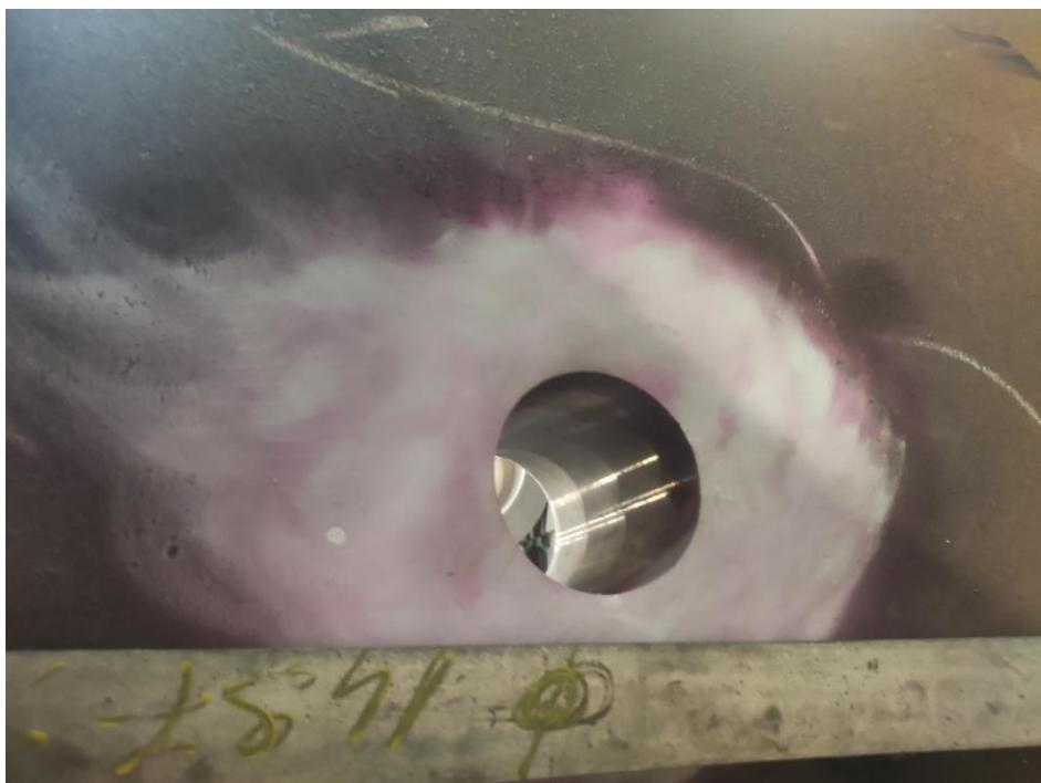
Slika 64 Ispitivanje penetrantom zavarenog spoja plašta i nabe
