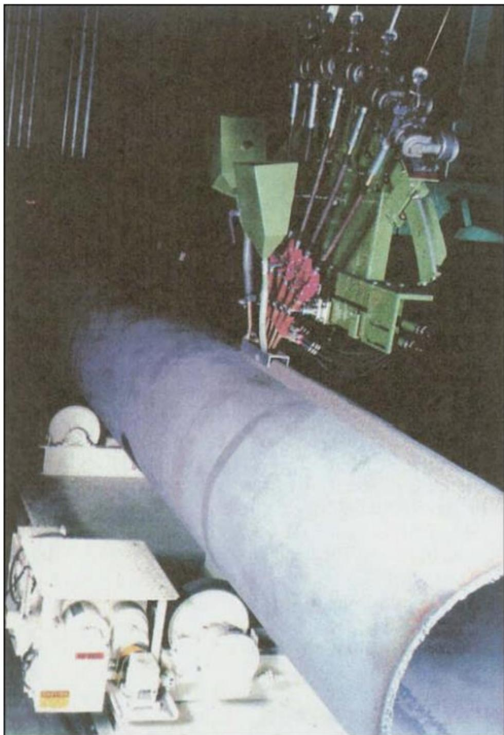
Slika 39 Automatsko zavarivanje cijevi s 5 elektroda [20]
