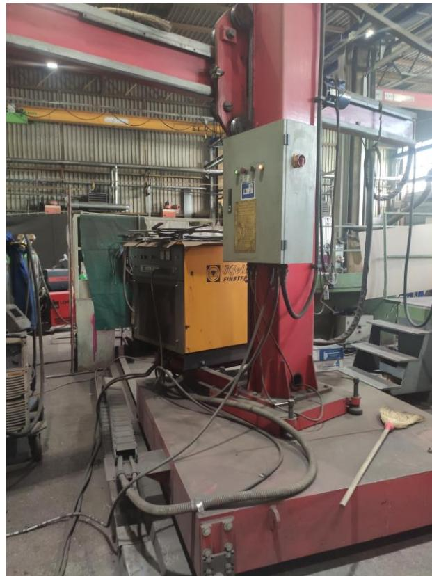
Slika 52 Izvor struje za EPP zavarivanje
