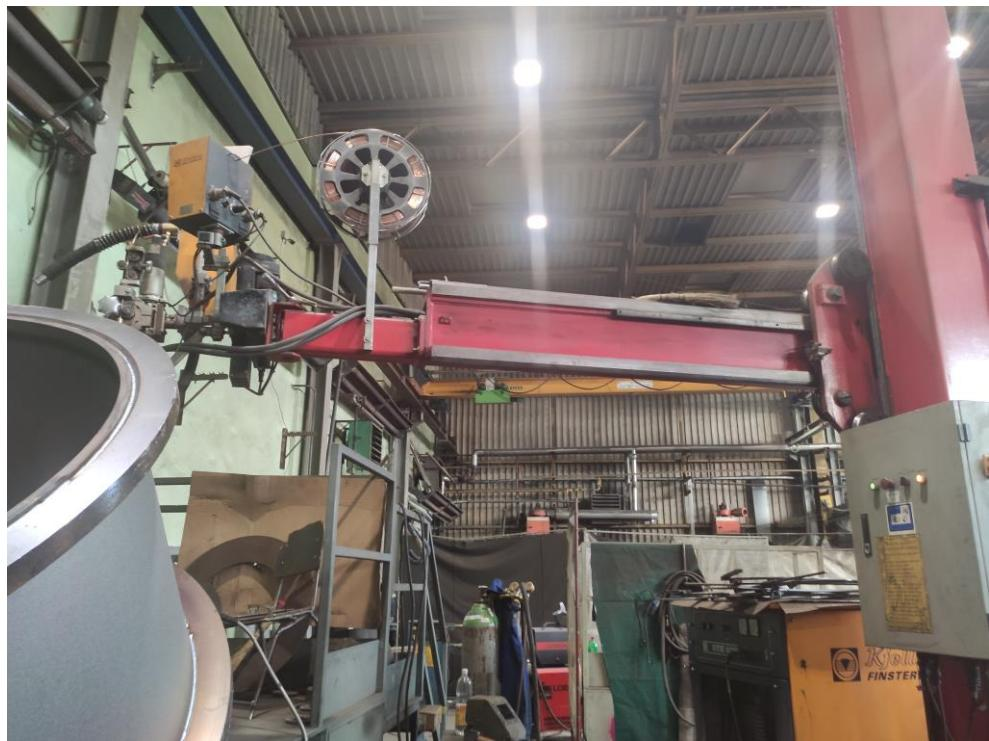
*Slika 54 Ruka sa pištoljem za EPP zavarivanje*
