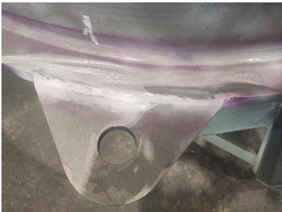
Slika 65 Ispitivanje penetrantom zavarenog spoja kućišta i uški
