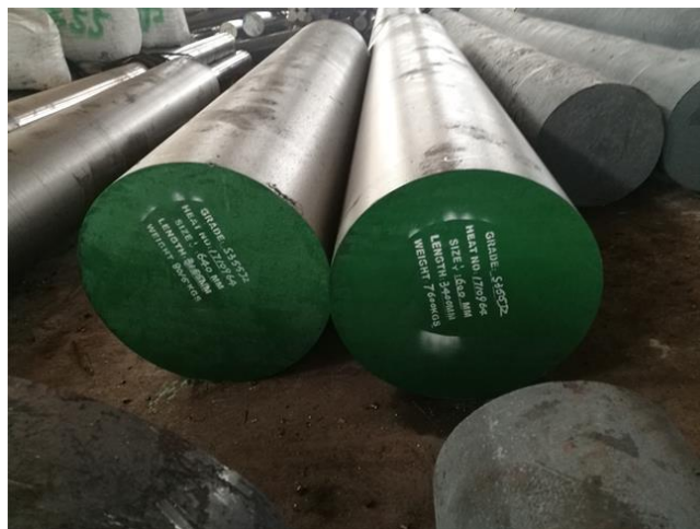
Slika 10 Čelik S355J2 + N u šipkastom obliku [11]
