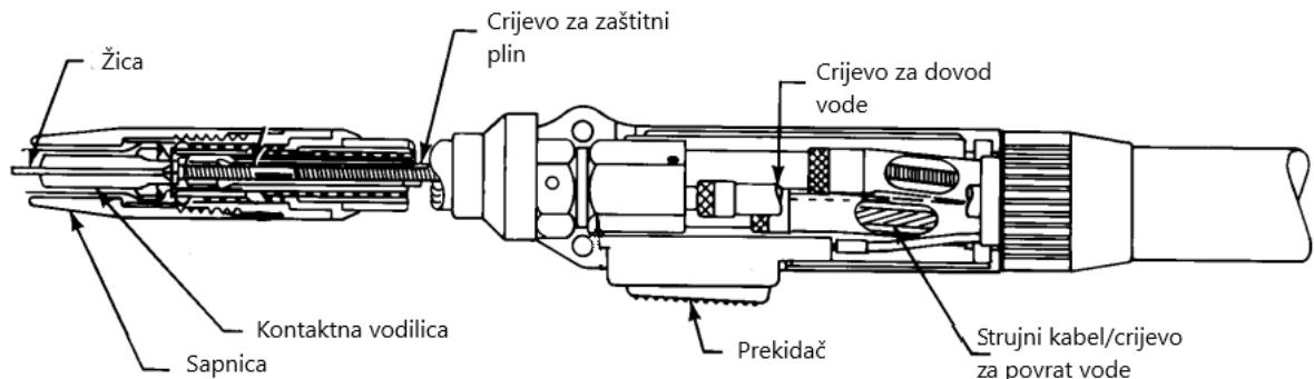
Slika 20 Shematski prikaz pištolja za zavarivanje MIG/MAG postupkom [20]
