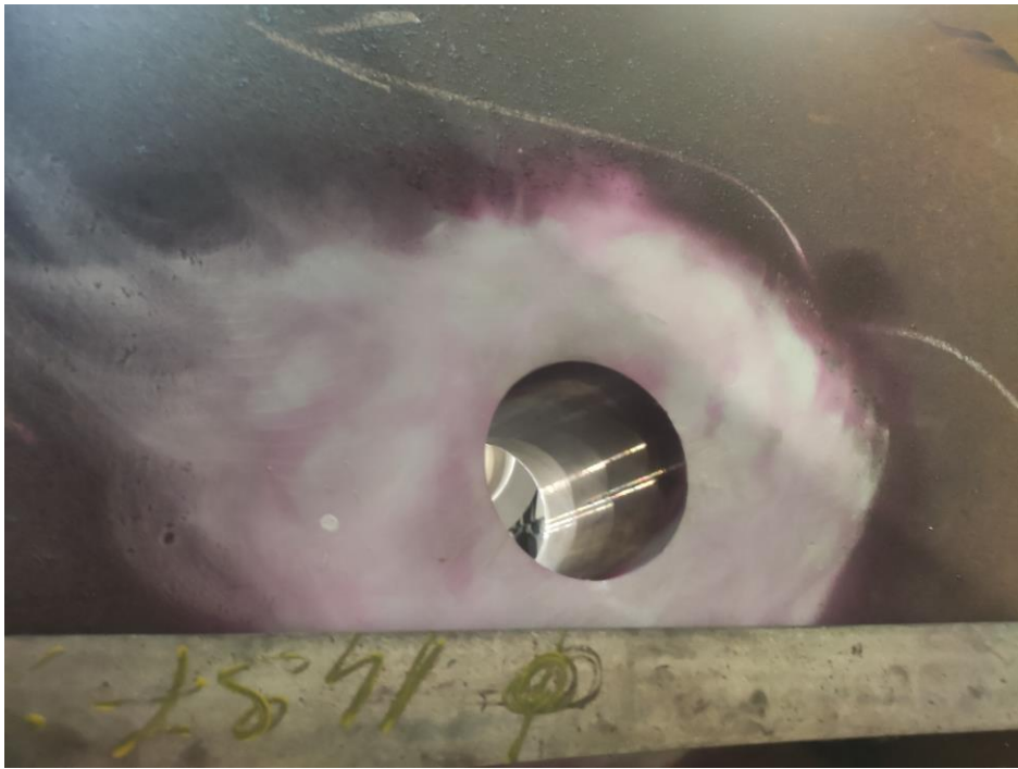
Slika 64 Ispitivanje penetrantom zavarenog spoja plašta i nabe
