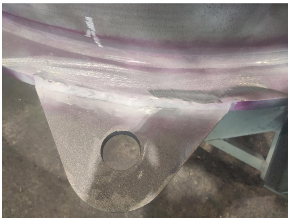
Slika 64 Ispitivanje penetrantom zavarenog spoja plašta i nabe
