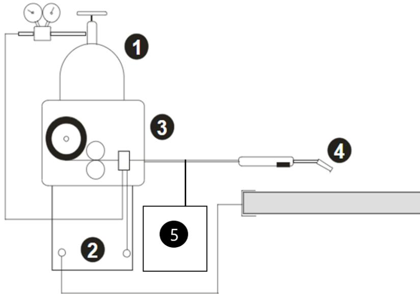
Slika 14 Prikaz sustava za MAG zavarivanje [1]
