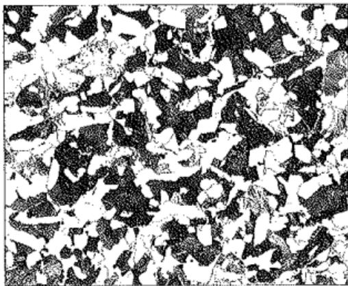
Slika 7 Mikrostruktura općeg konstrukcijskog čelika s 0,25% C [6]
