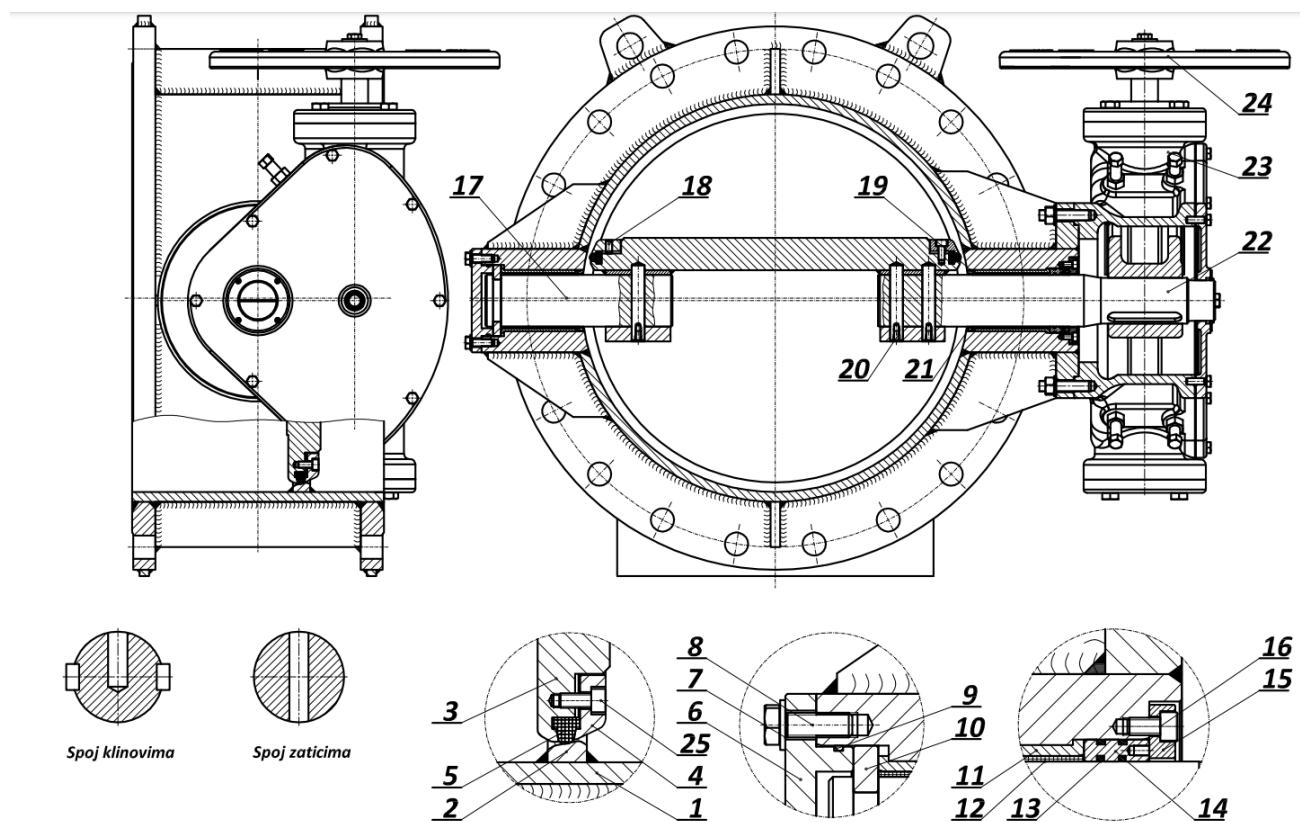
Slika 5 Standardni dijelovi leptirastog zatvarača [5]
