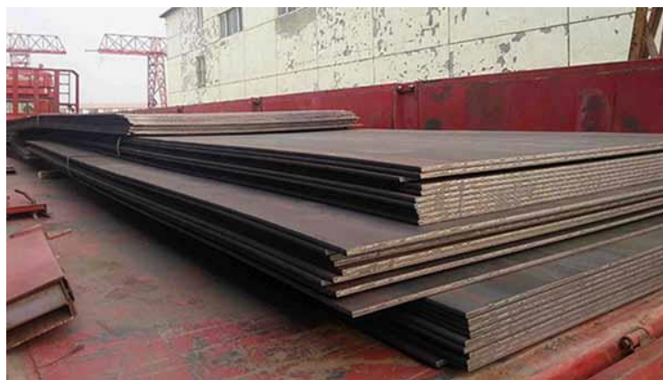
Slika 11 Čelik S355J2 + N u obliku ploča [12]
