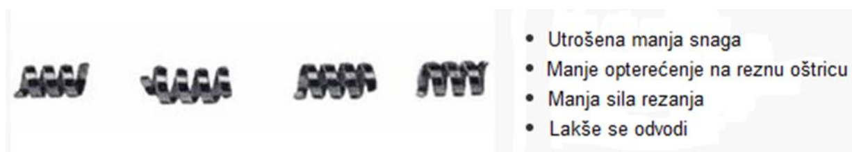
Slika 17 - Kratka spiralna odvojena čestica [15]
