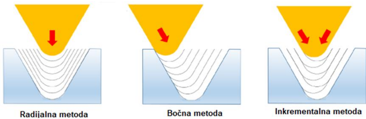
Slika 15 - Metode ulaska rezne pločice u zahvat [13]
