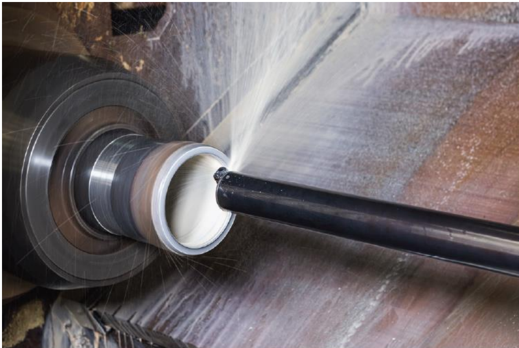
Slika 28 - Držač za unutarnje tokarenje s polijevanjem na vrh pločice [30]
