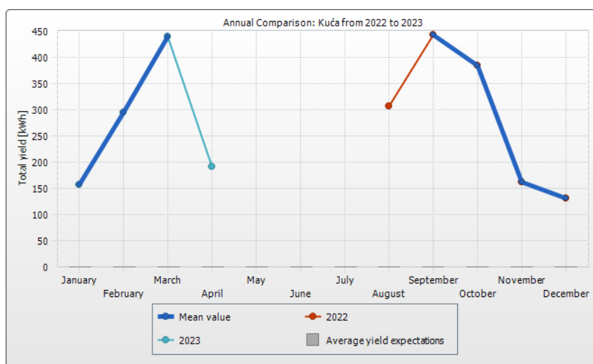
Slika 7.3. Usporedba proizvodnje predmetne solarne elektrane u 2022. i 2023. godini
