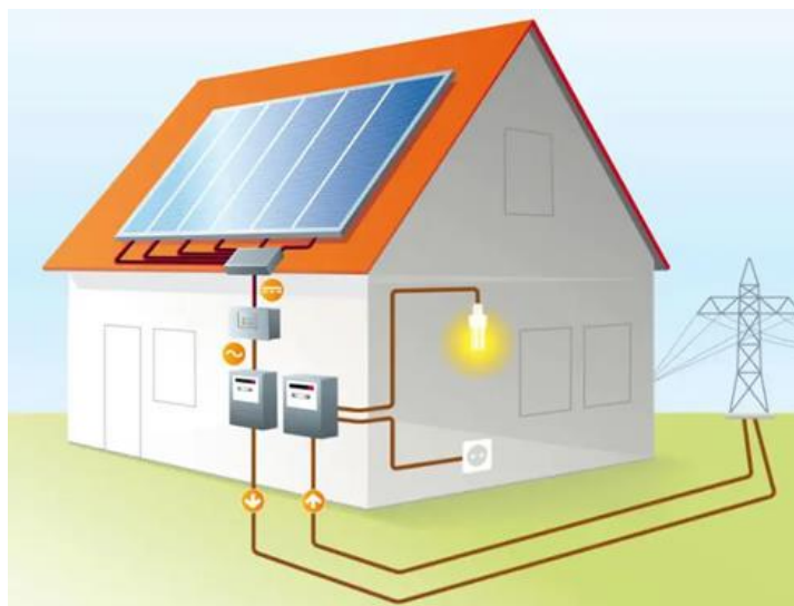
Slika 2.4. FN sustav izravno priključen na distribucijsku mrežu [4]
