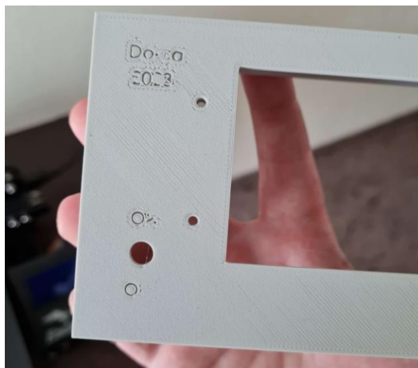
Slika 6.2. – prednji dio kućišta, isprintan
