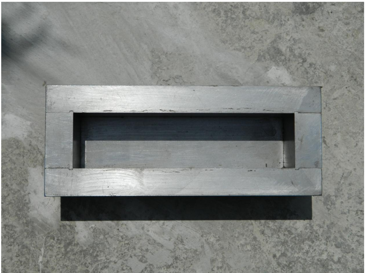
Slika 20 Kalup za betoniranje betonskih prizmi
