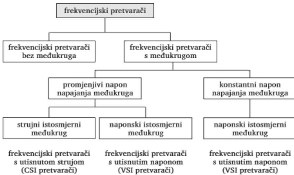
Slika 2.1. Podjela frekventnih pretvarača [2]
