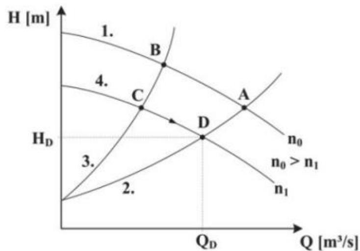
Slika 8.3. Povećanje protoka uz konstantnu visinu dobave pumpe [20]
