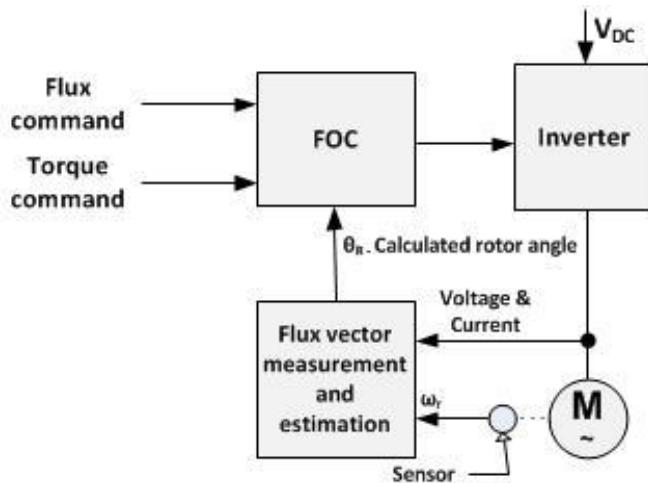
Slika 5.2. Pojednostavljena blokovska shema direktnog vektorskog upravljanja (DFOC) [9]
