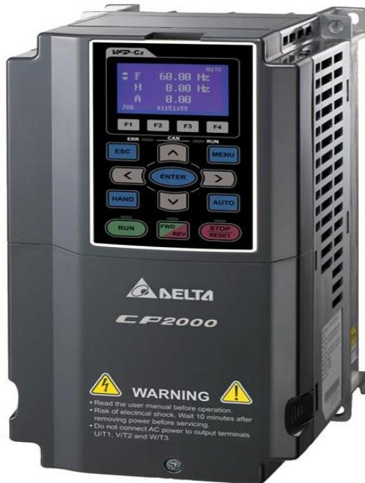
Slika 4.1. Delta CP2000 s ugrađenim PID regulatorom [8]
