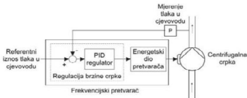
Slika 8.4. Regulacija tlaka sustava pomoću PID regulatora [20]
