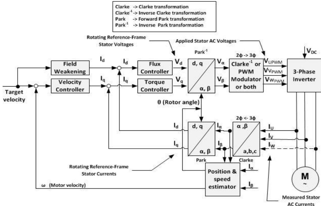
Slika 5.5. Blokovska shema vektorskog upravljanja bez senzora (SFOC) [9]
