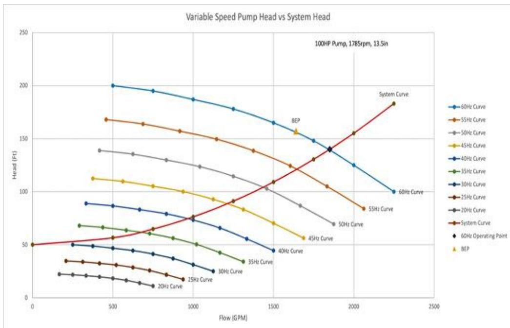
Slika 8.1. Prikaz krivulji pumpi za pojedinu frekvenciju [19]
