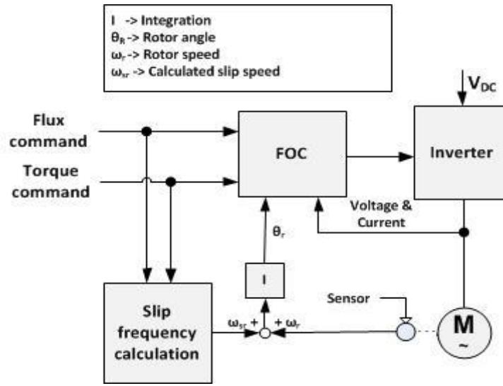
Slika 5.3. Pojednostavljena blokovska shema indirektnog vektorskog upravljanja (IFOC) [9]
